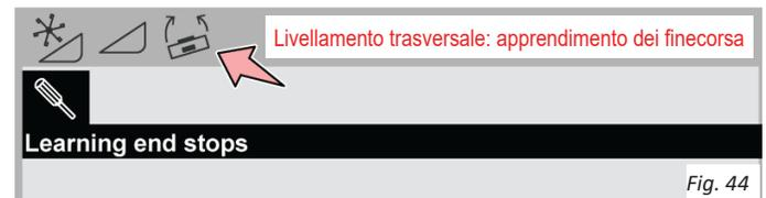
6. Eseguire la procedura di apprendimento dei finecorsa nella sezione Altezza attacco anteriore del menu.
