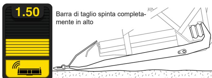
Fig. 133 - Grafico a barre del sensore - Barra di taglio spinta verso l'alto
