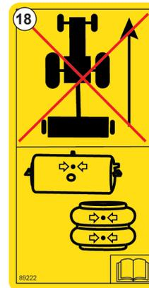
Fig. 20 - Assicurarsi che il sistema dell'aria sia completamente pressurizzato prima del trasporto - N. 89222
