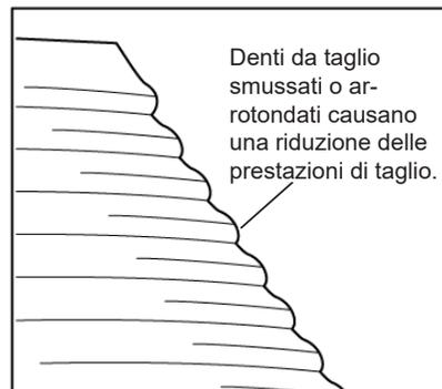
Fig. 221 - Usura della sezione di taglio
