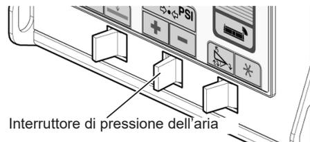
Fig. 117 - Impostare la pressione dell'aria a 30-90 psi
