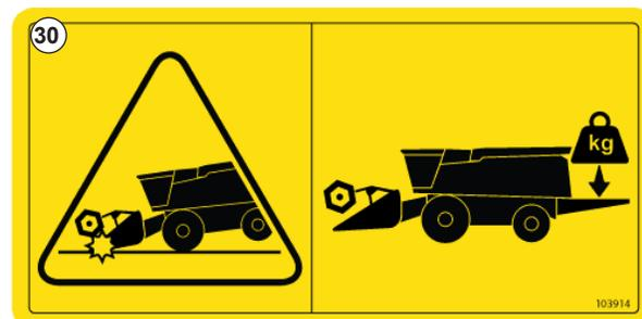
Fig. 32 - Avvertenza: assicurarsi che la mietitrebbia sia correttamente zavorrata prima dell'uso - N. 103914
