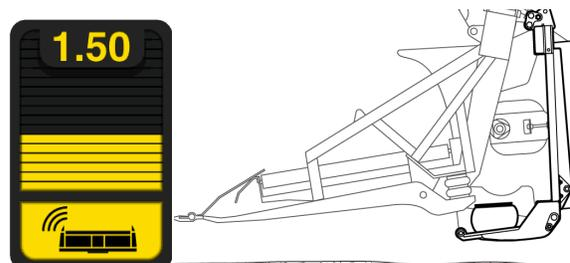
Fig. 135 - Grafico a barre del sensore - Testata spinta verso l'alto
