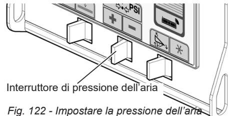
Fig. 122 - Impostare la pressione dell'aria
