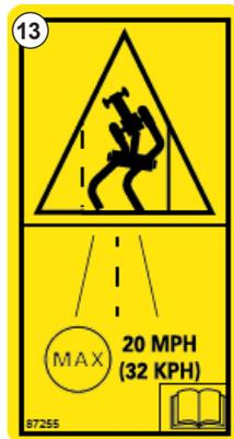
Fig. 15 - Avvertenza sul rischio di incidente: non superare i 32 km/h (20 mph) - N. 87255
