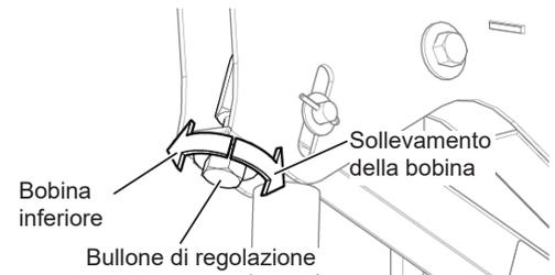
Fig. 198 - Bullone di regolazione dell'altezza della bobina
