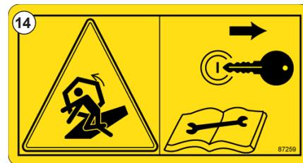
Fig. 16 - Avvertenza sulle parti rotanti: spegnere l'apparecchiatura e leggere il manuale prima di eseguire la manutenzione - N. 87259
