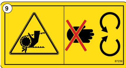
Fig. 11 - Avvertenza sul rischio di intrappolamento: non toccare - N. 87239
