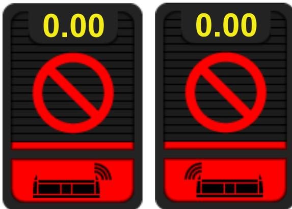
Fig. 138 - Avvertenza! Sensore di altezza della testata non rilevato
