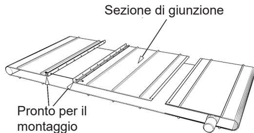
Fig. 183 - Giunzione del draper
