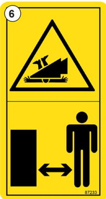
Fig. 8 - Avvertenza sul rischio di schiacciamento: mantenere la distanza di sicurezza - N. 87233
