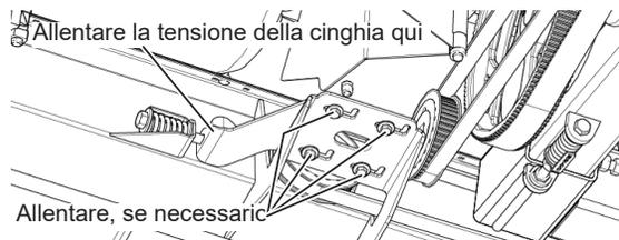
Fig. 161 - Cinghia di trasmissione del draper sinistro allentata
