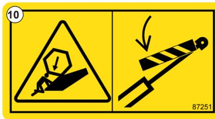
Fig. 12 - Avvertenza sul rischio di caduta della bobina: bloccare il braccio della bobina durante la manutenzione - N. 87251
