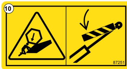
Abb. 12 - Warnung vor dem Herunterfallen der Trommel, Verriegelung des Trommelarms bei Wartungsarbeiten - #87251
