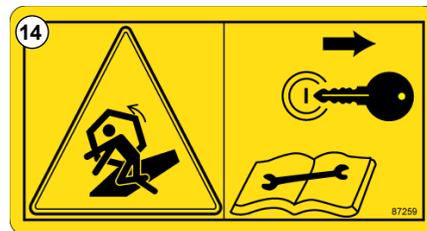
Abb. 16 - Warnung vor rotierenden Teilen – Maschine ausschalten und vor der Wartung Bedienungsanleitung beachten - #87259
