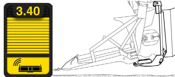
Abb. 133 - Sensor-Balkendiagramm – Schneidwerk über vollen Bereich verfügbar
