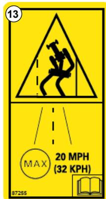
Abb. 15 - Kollisionswarung, nicht schneller als 32 km/h fahren - #87255
