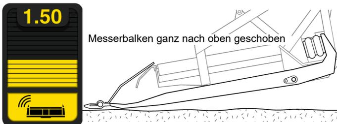
Abb. 132 - Sensor-Balkendiagramm – Messerbalken nach oben geschoben
