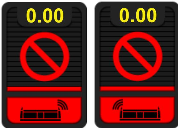
Abb. 137 - Warnung! Höhensensor des Schneidwerks nicht erkannt!
