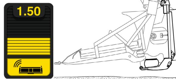
Abb. 134 - Sensor-Balkendiagramm – Schneidwerk nach oben geschoben
