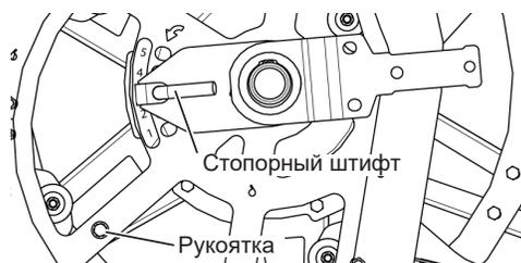
Рис. 109 - Регулировка кулачкового мотовила
