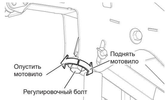
Рис. 198 - Болт для регулировки высоты мотовила.
