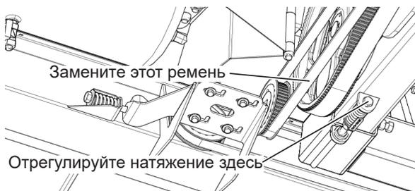
Рис. 160 - Снятие первого ремня левого полотенного транспортера.
