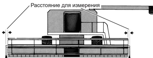
Рис. 63 - Выравнивание мотовила по центру
