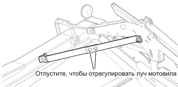
Рис. 64 - Центрирование мотовила — кронштейн концевого луча мотовила
