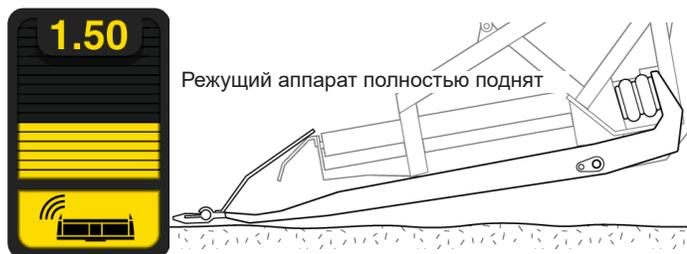
Рис. 133 - Панель оперативных данных - Режущий аппарат поднят
