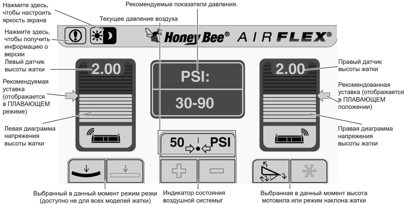
Рис. 129 - Панель управления Automatrix
