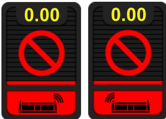
Рис. 138 - Предупреждение! Датчик высоты жатки не обнаружен!
