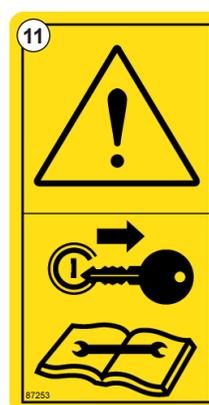
Рис. 13 - Для технического обслуживания выключите двигатель. - #87253
