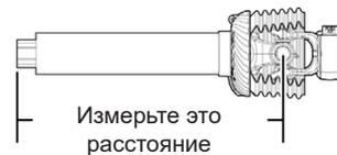
Рис. 312 - Измерение вала
