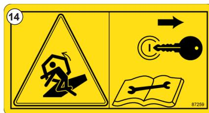
Рис. 16 - Для технического обслуживания мотовила выключите двигатель. - #87259
