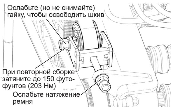
Рис. 158 - Регулировка ремня привода подающего шнека
