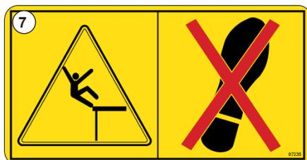
Рис. 9 - Ступенька отсутствует: опасность падения. - #87235
