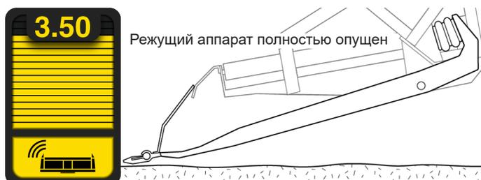
Рис. 132 - Панель оперативных данных - Доступен полный диапазон движения режущего аппарата
