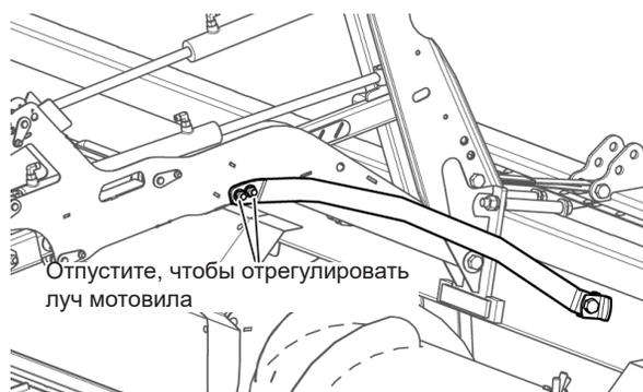
Рис. 65 - Центрирование мотовила — кронштейн центрального луча мотовила
