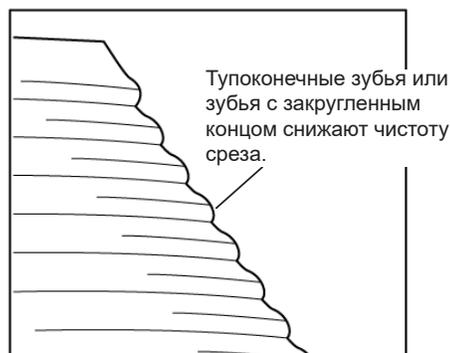
Рис. 222 - Износ режущего сегмента
