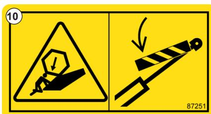
Рис. 12 - Перед проведением технического обслуживания установите фиксатор мотовила. - #87251
