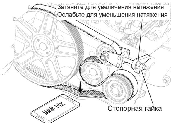
Рис. 145 - Натяжение приводного ремня подающего шнека.
