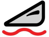
Si la anulación del flotador de presión es demasiado baja o el cabezal golpea el suelo con fuerza, enviará el cabezal a la anulación de presión. Cuando lo haga, aparecerá una línea ondulada y una flecha hacia arriba. Es posible que sea necesario pulsar el botón de reanudación.
