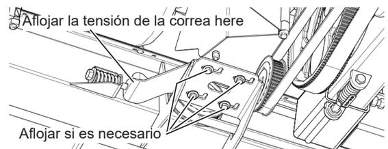
Fig. 161 - Aflojar tensión de correa de transmisión de la banda transportadora izquierda
