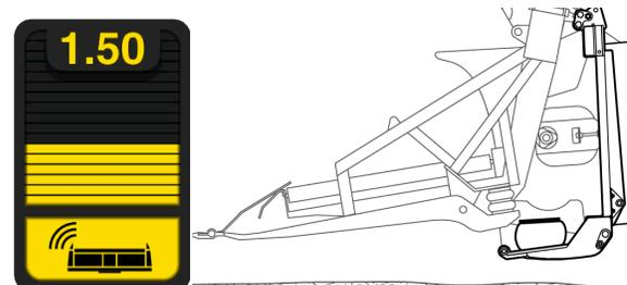
Fig. 135 - Gráfico de barras del sensor - Cabezal empujado hacia arriba
