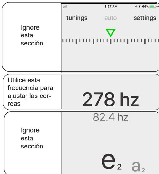
Fig. 143 - iOS - Aplicación Fine Tuner
