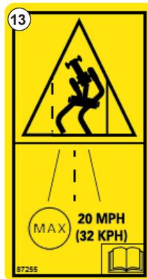
Fig. 15 - Aviso de colisión, no superar los 32 km/h (20 mph) - n.º 87255
