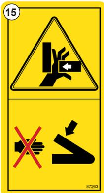
Fig. 17 - Advertencia de pinzamiento, manténgase alejado de las piezas móviles - n.º 87263
