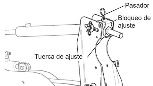
Fig. 200 - Ajuste de la altura del brazo del carrete central
