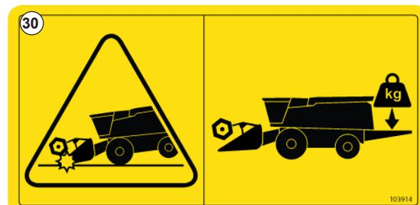
Fig. 32 - Advertencia de vuelco, asegúrese de que la cosechadora esté correctamente lastrada antes del uso - #103914
