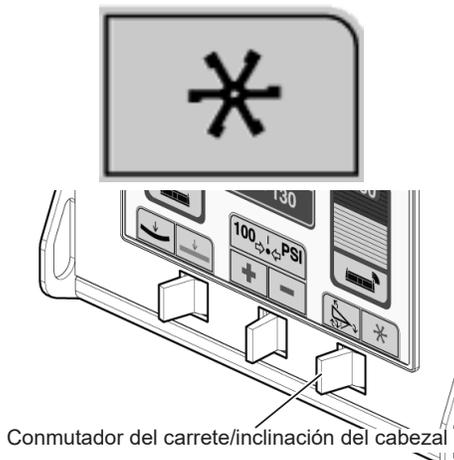
Fig. 111 - Active el modo de altura del carrete
