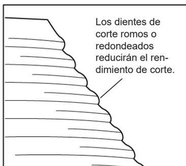
Fig. 223 - Desgaste de la sección de corte
