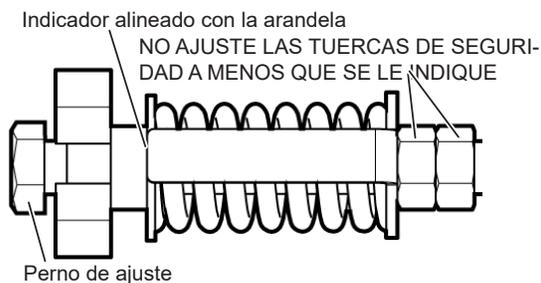
Fig. 142 - Posición del indicador de tensión
