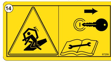
Fig. 16 - Advertencia de pieza giratoria, apague el equipo y lea el manual antes de realizar el mantenimiento - n.º 87259
