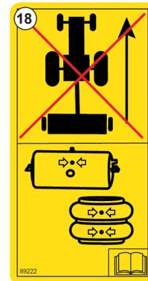
Fig. 20 - Asegúrese de que el sistema de aire esté completamente presurizado antes de transportarlo - n.º 89222
