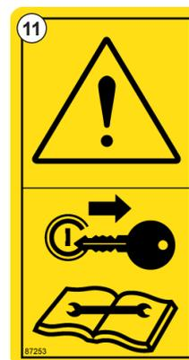
Fig. 13 - Apague el equipo y lea el manual antes de repararlo - n.º 87253
