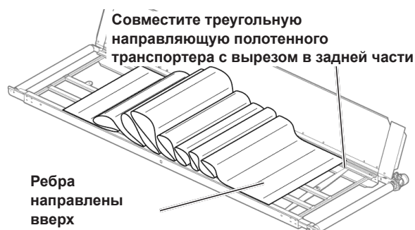
Рис. 92 - Разворачивание полотенного транспортера
