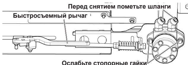
Рис. 103 - Снятие ведущего ролика
