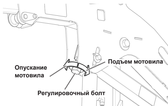
Рис. 81 - Регулировка высоты центрального луча мотовила
