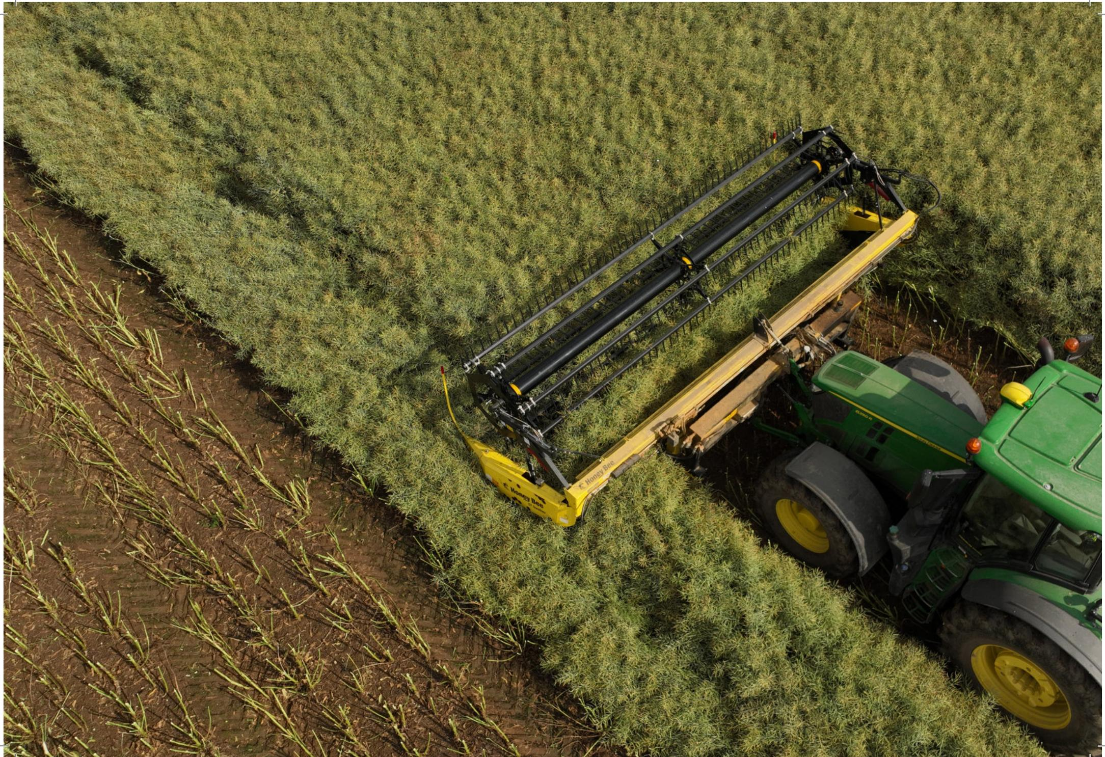
Доступны с шириной от 15 до 36 футов, свальные жатки HoneyBee серии ST агрегируются с любым трактором с мощностью от 100 л.с. и наличием передней или задней 3-х точечной навески. За счет простого и быстрого подключения жатку легко переводить в транспортировочное положение для ее перевозки по узким дорогам.
