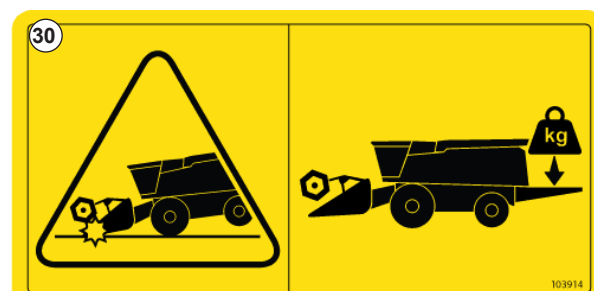
Abb. 32 - Kippgefahr: Sicherstellen, dass der Mähdrescher vor dem Betrieb ordnungsgemäß mit Ballast beladen ist - #103914
