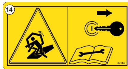
Abb. 16 - Warung vor rotierenden Teilen – Maschine ausschalten und vor der Wartung Bedienungsanleitung beachten - #87259
