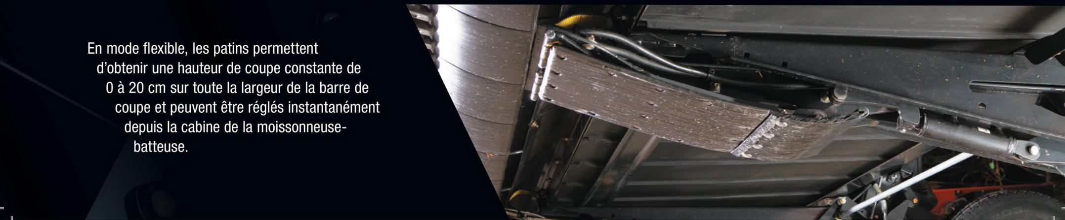
En mode flexible, les patins permettent d'obtenir une hauteur de coupe constante de 0 à 20 cm sur toute la largeur de la barre de coupe et peuvent être réglés instantanément depuis la cabine de la moissonneuse-batteuse.
