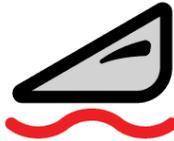
Si la anulación del flotador de presión se ajusta demasiado baja o el cabezal golpea el suelo con fuerza, enviará el cabezal a la anulación de presión. Cuando lo haga, aparecerá una línea ondulada y una flecha hacia arriba.
