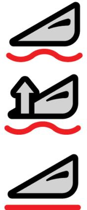
Si la anulación del flotador de presión es demasiado baja o el cabezal golpea el suelo con fuerza, enviará el cabezal a la anulación de presión. Cuando lo haga, aparecerá una línea ondulada y una flecha hacia arriba. Es posible que sea necesario pulsar el botón de reanudación.
