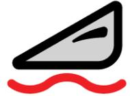
Si la anulación del flotador de presión se ajusta demasiado baja o el cabezal golpea el suelo con fuerza, enviará el cabezal a la anulación de presión. Cuando lo haga, aparecerá una línea ondulada y una flecha hacia arriba.
