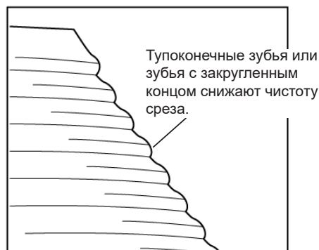
Рис. 222 - Износ режущего сегмента
