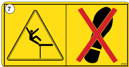
Рис. 9 - Ступенька отсутствует: опасность падения. - #87235
