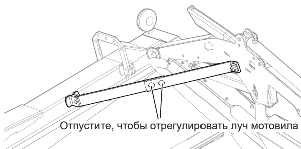
Рис. 64 - Центрирование мотовила — кронштейн концевой луча мотовила
