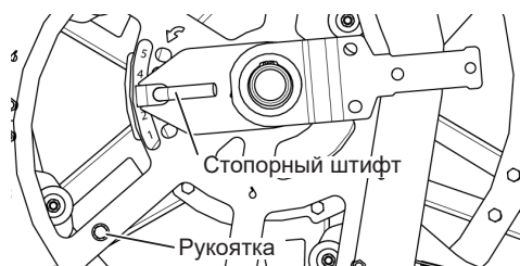
Рис. 109 - Регулировка кулачкового мотовила
