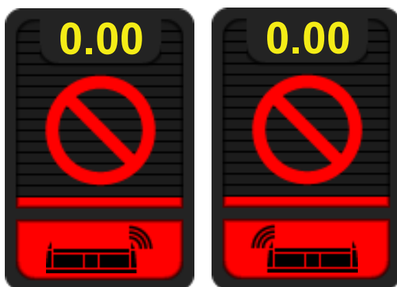
Рис. 138 - Предупреждение! Датчик высоты жатки не обнаружен!
