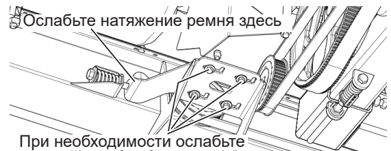
Рис. 161 - Ослабление натяжения приводного ремня левого полотенного транспортера.
