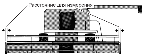
Рис. 63 - Выравнивание мотовила по центру
