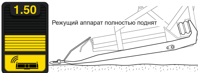
Рис. 133 - Панель оперативных данных - Режущий аппарат поднят
