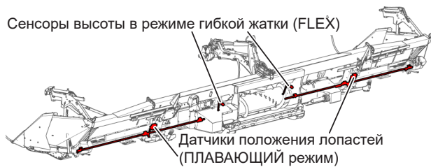
Рис. 37 - AirFLEX Места расположения сенсоров системы контроля высоты жатки
