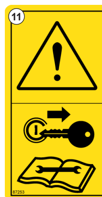
Рис. 13 - Для технического обслуживания выключите двигатель. - #87253
