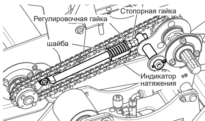
Рис. 148 - Регулировка натяжения приводной цепи центрального транспортера
