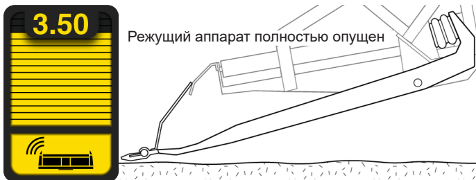
Рис. 132 - Панель оперативных данных - Доступен полный диапазон движения режущего аппарата
