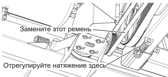
Рис. 160 - Снятие первого ремня левого полотенного транспортера.
