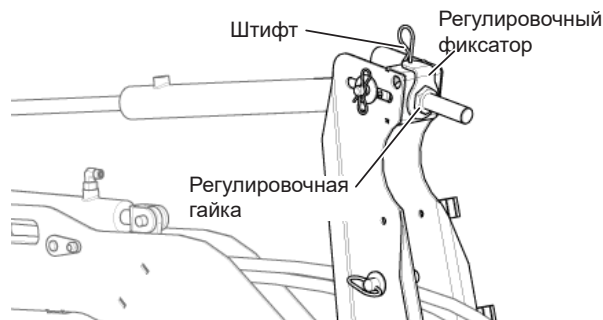
Рис. 61 - Регулировка высоты центрального луча мотовила.
