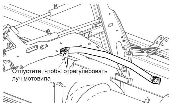
Рис. 65 - Центрирование мотовила — кронштейн центрального луча мотовила
