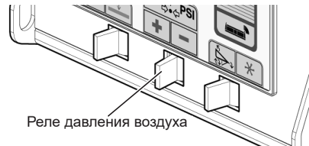
Рис. 117 - Установите давление воздуха до 30-65 фунты на кв. дюйм
