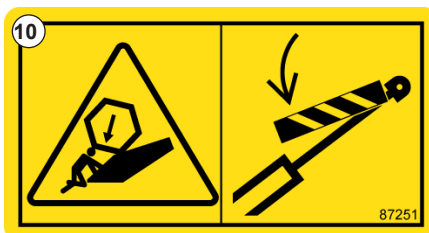
Рис. 12 - Перед проведением технического обслуживания установите фиксатор мотовила. - #87251
