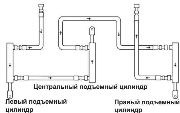
Рис. 79 - Подъемные цилиндры раздельного мотовила
