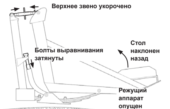
Рис. 44 - Пример С Болты затянуты, звено укорочено
