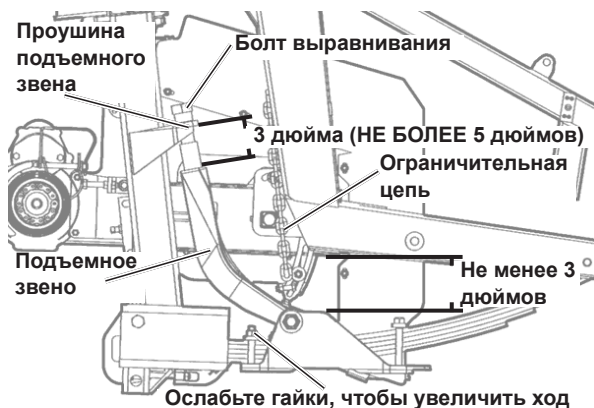
Рис. 31 - Подрамник жатки. Вид сбоку
