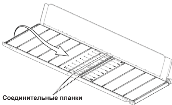
Рис. 93 - Соединение концов полотна соединительными планками
