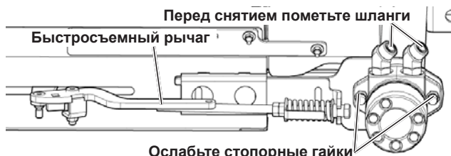
Рис. 102 - Снятие ведущего ролика
