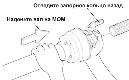
Рис. 138 - Подсоединение приводного вала
