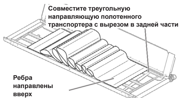
Рис. 91 - Разворачивание полотенного транспортера
