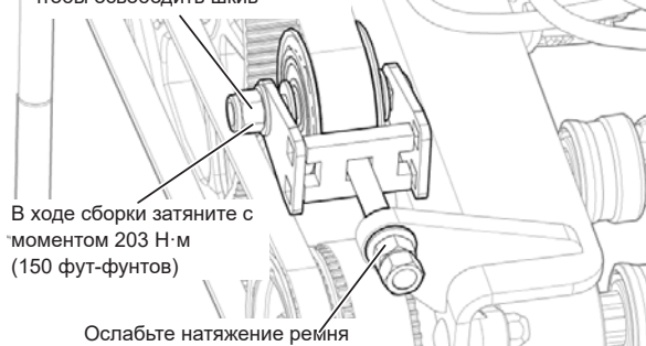
Рис. 172 - Регулировка приводного ремня подающего шнека
