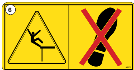
Рис. 9 - Ступенька отсутствует: опасность падения.
