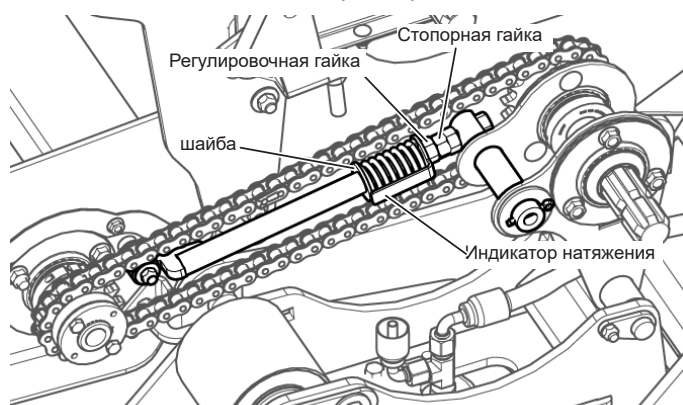
Рис. 162 - Регулировка натяжения приводной цепи центрального транспортера
