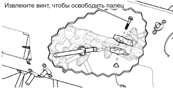
Рис. 261 - Замена пальцев подающего шнека.
