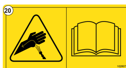
Рис. 23 - Опасность в связи с жидкостями высокого давления.
