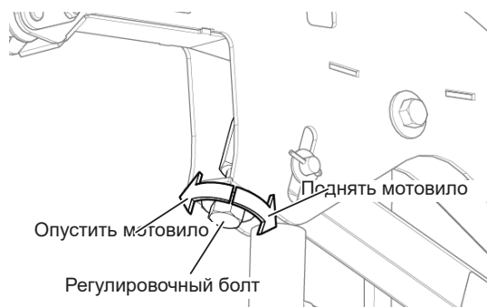
Рис. 213 - Болт для регулировки высоты мотовила.
