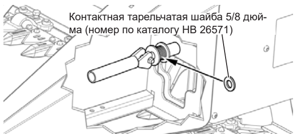
Рис. 253 - Установка дополнительной шайбы для закрепления расшатанной рукоятки.
