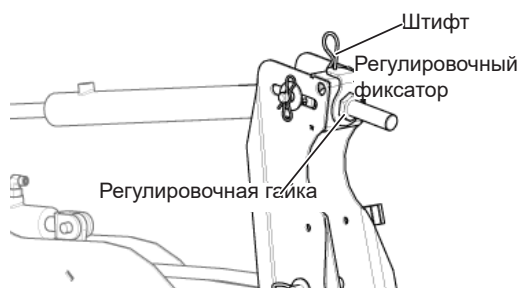
Рис. 214 - Регулировка высоты центрального луча мотовила.
