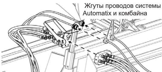
Рис. 53 - Подсоединение многоцелевого разъема и жгутов проводов.
