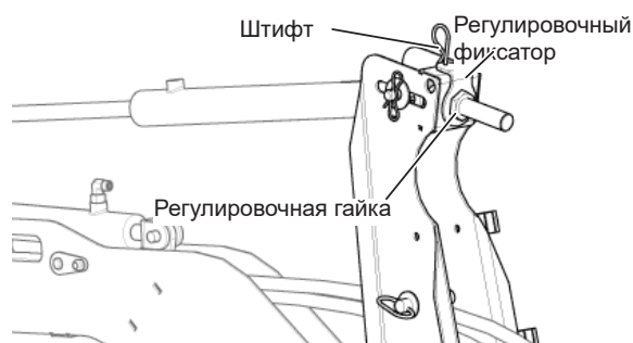
Рис. 62 - Регулировка высоты центрального луча мотовила.
