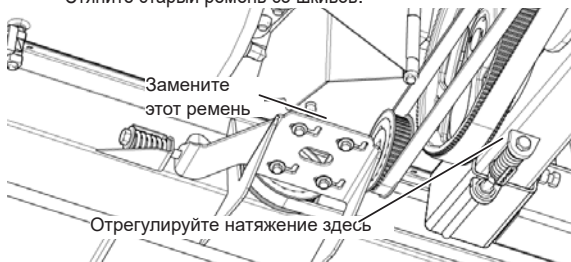
Рис. 174 - Снятие первого ремня левого полотенного транспортера.
