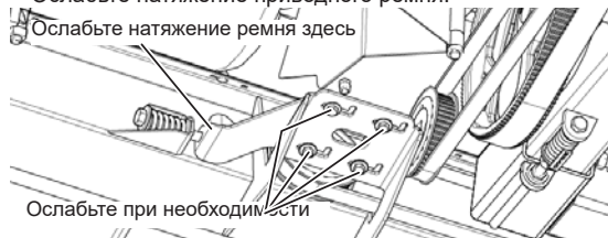
Рис. 176 - Ослабление натяжения приводного ремня левого полотенного транспортера.
