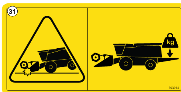
Рис. 34 - Правильно нагружайте комбайн балластом.
