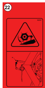
Рис. 25 - Зафиксируйте мотовило пальцы перед операцией
