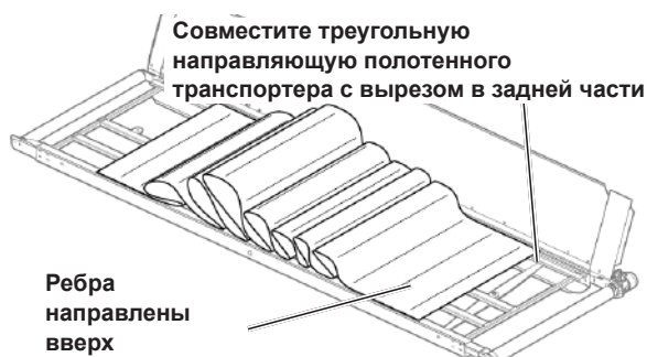
Рис. 91 - Разворачивание полотенного транспортера
