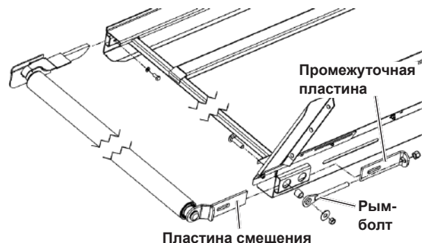
Рис. 101 - Выравнивание промежуточного полотенного транспортера
