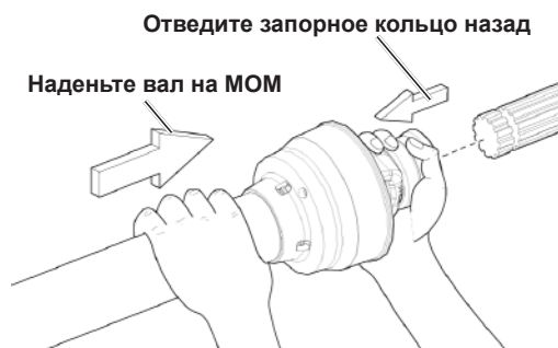
Рис. 138 - Подсоединение приводного вала
