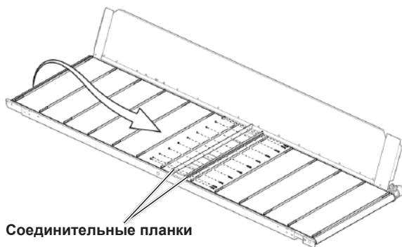
Рис. 93 - Соединение концов полотна соединительными планками
