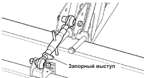
Рис. 35 - Угол наклона вперед — ручная регулировка
