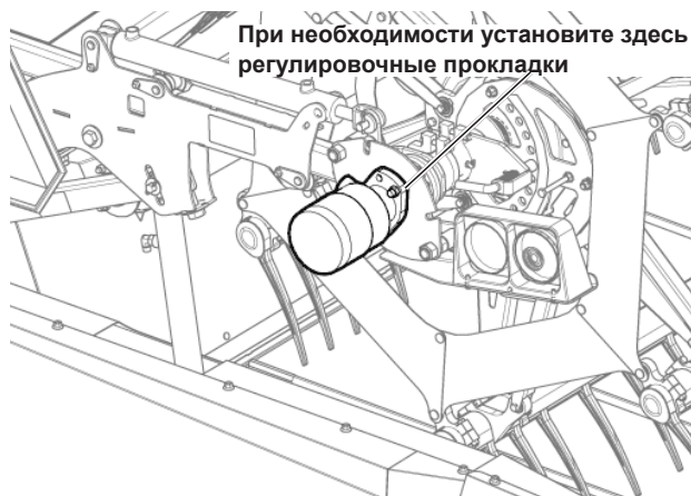
Рис. 77 - Выравнивание привода мотовила
