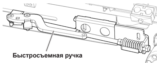
Рис. 90 - Регулировка натяжения полотенного транспортера
