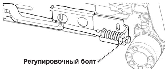
Рис. 95 - Регулировка натяжения полотенного транспортера
