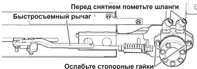
Рис. 102 - Снятие ведущего ролика
