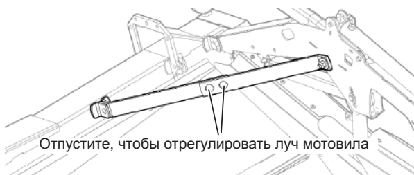
Рис. 74 - Центрирование мотовила — кронштейн концевой луча мотовила
