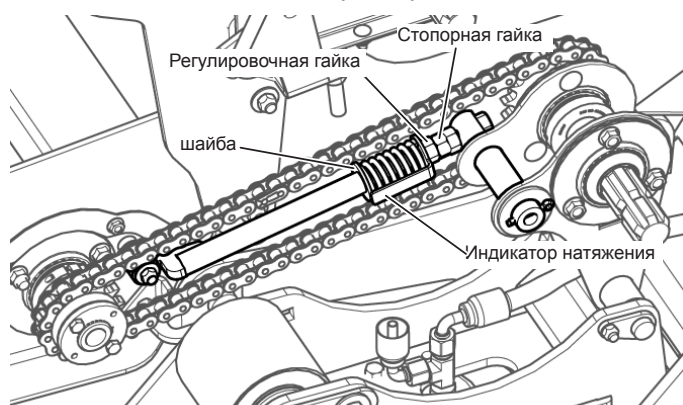
Рис. 157 - Регулировка натяжения приводной цепи центрального транспортера
