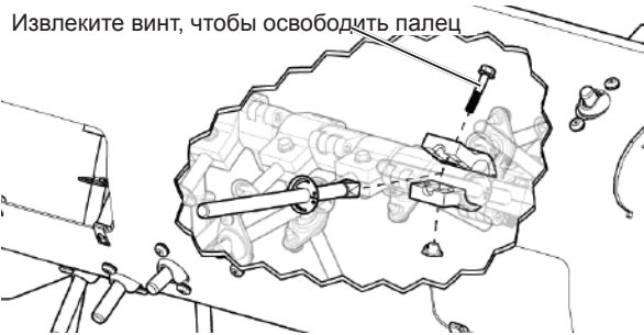
Рис. 256 - Замена пальцев подающего шнека.
