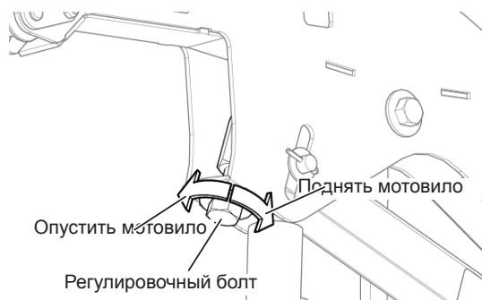
Рис. 208 - Болт для регулировки высоты мотовила.
