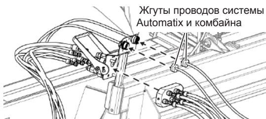
Рис. 53 - Подсоединение многоцелевого разъема и жгутов проводов.
