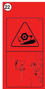
Рис. 25 - Зафиксируйте мотовило пальцы перед операцией
