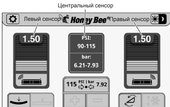
Рис. 307 - Идентификация сенсоров системы контроля высоты жатки на дисплее Automatix.
