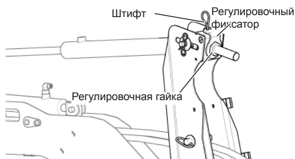
Рис. 71 - Регулировка высоты центрального луча мотовила.
