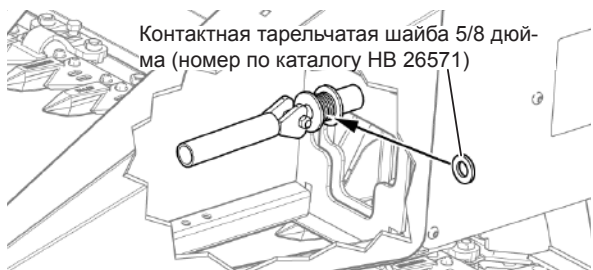
Рис. 248 - Установка дополнительной шайбы для закрепления расшатанной рукоятки.
