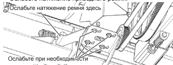
Рис. 171 - Ослабление натяжения приводного ремня левого полотенного транспортера.
