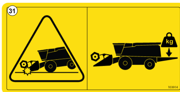
Рис. 34 - Правильно нагружайте комбайн балластом.
