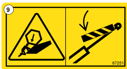
Рис. 12 - Перед проведением технического обслуживания установите фиксатор мотовила.
