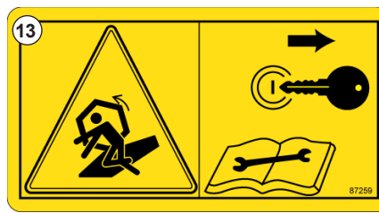
Рис. 16 - Для технического обслуживания мотовила выключите двигатель.
