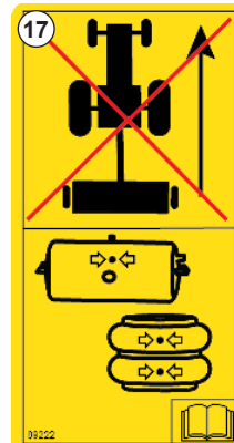
Рис. 20 - Не осуществляйте транспортировку, если из пневматических подушек выпущен воздух.
