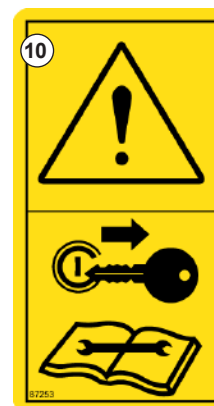
Рис. 13 - Для технического обслуживания выключите двигатель.
