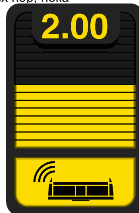
Рис. 123 - Установите давление воздуха до 25-65 PSI
