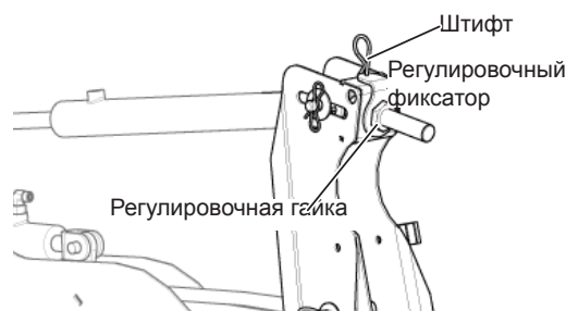
Рис. 209 - Регулировка высоты центрального луча мотовила.
