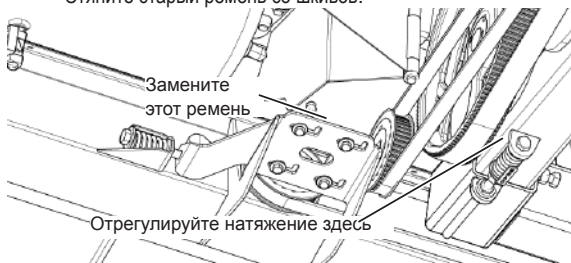
Рис. 169 - Снятие первого ремня левого полотенного транспортера.
