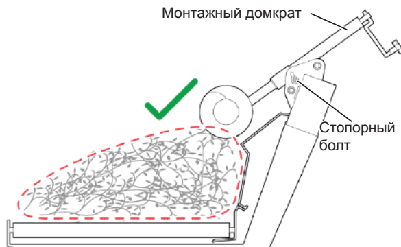
Рис. 87 - Регулировка расстояния между прижимным устройством и режущей секцией.
