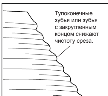
Рис. 233 - Износ режущего сегмента
