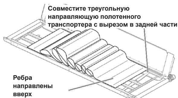
Рис. 87 - Разворачивание полотенного транспортера
