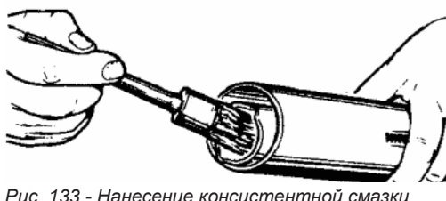
Рис. 133 - Нанесение консистентной смазки внутри вала кистью
