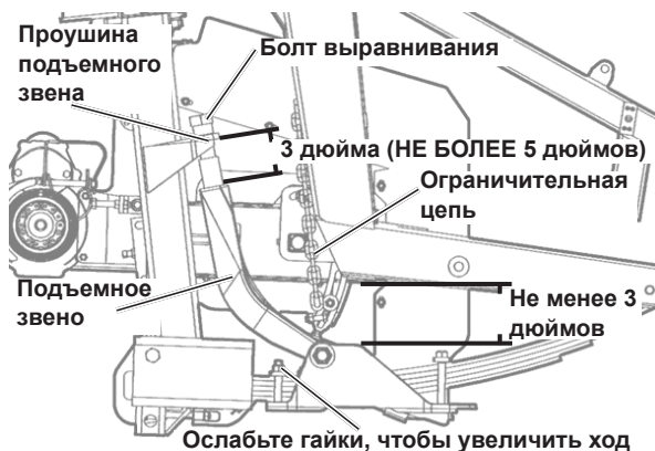
Рис. 31 - Подрамник жатки. Вид сбоку
