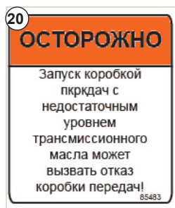
Рис. 22 - Знак — предупреждение о смазке редуктора
