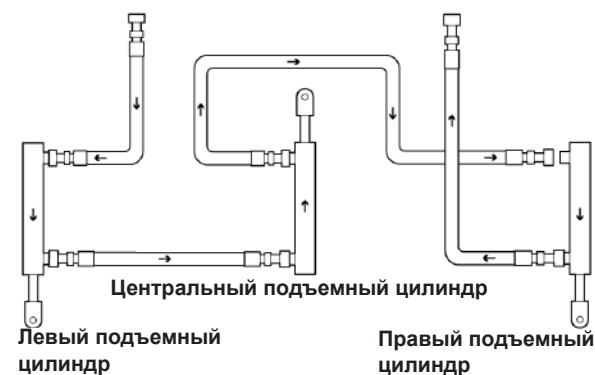
Рис. 72 - Подъемные цилиндры раздельного мотовила
