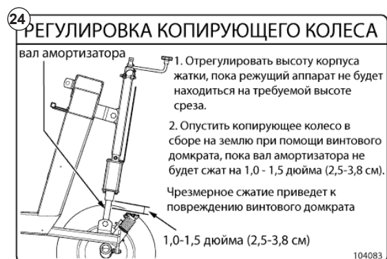
Рис. 26 - Инструкции по эксплуатации копирующего колеса
