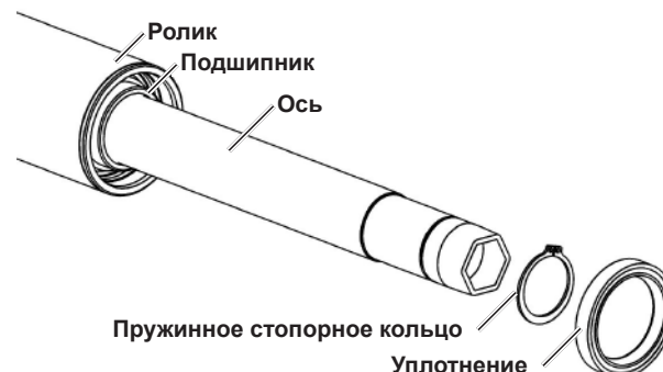
Рис. 101 - Подшипник промежуточного ролика
