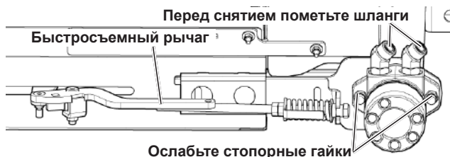
Рис. 98 - Снятие ведущего ролика
