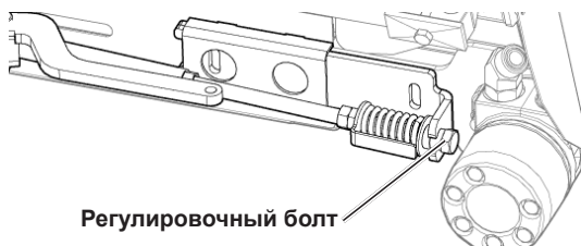
Рис. 91 - Регулировка натяжения полотенного транспортера
