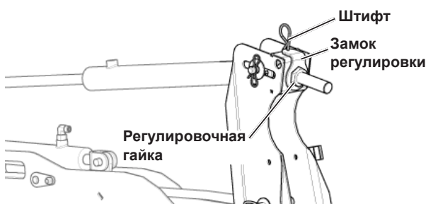
Рис. 75 - Регулировка высоты центрального луча мотовила
