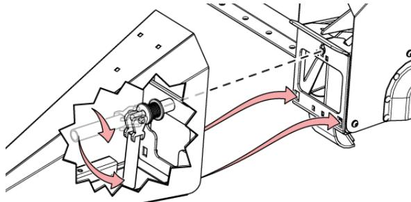
Рис. 236 - Дополнительная рукоятка делителя.
