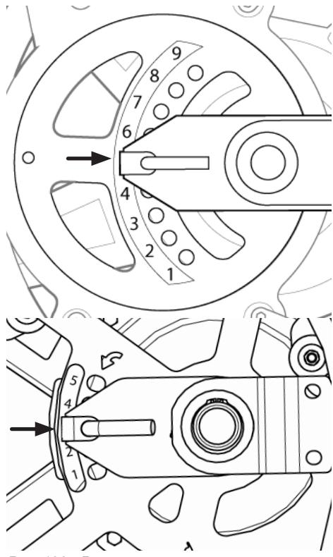
Рис. 190 - Регулировка пальцев мотовила
