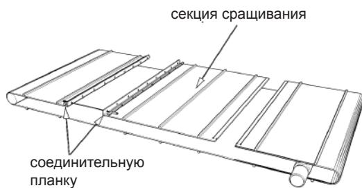
Рис. 186 - сращивания полотенного транспортера
