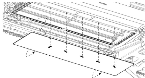
Рис. 182 - Снятие панели очистного люка центрального полотенного транспортера.
