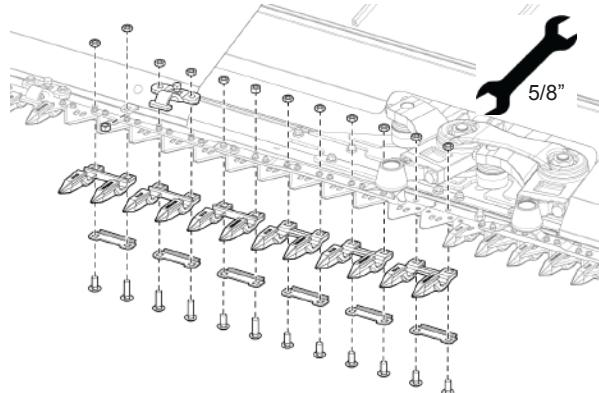
Рис. 219 - Снятие защитных устройств, которые окружают головку правого ножа
