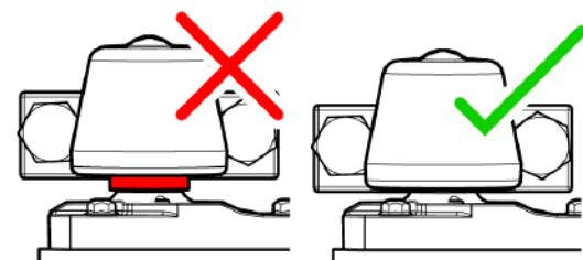
Рис. 225 - Проверка правильности установки корпуса подшипников
