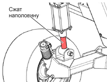
Рис. 121 - Опорное колесо сжато наполовину
