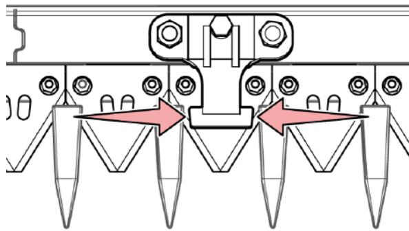
Рис. 230 - Выровняйте секцию режущей кромки на держателе
