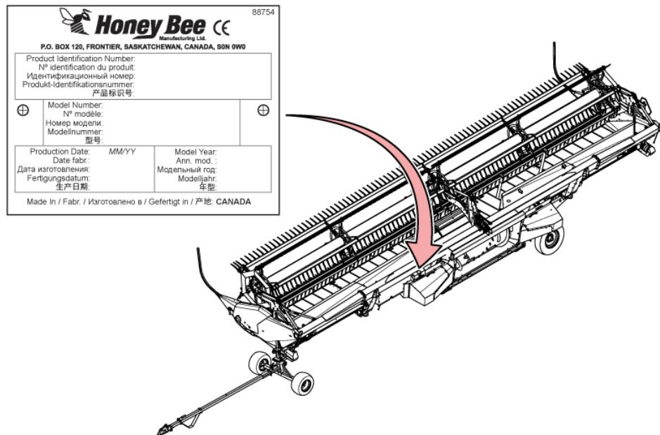
Рис. 1 - Место расположения таблички с серийным номером.
