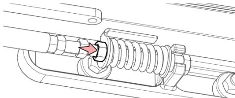
Рис. 180 - Затяните гайку
