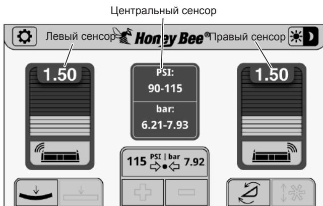
Рис. 296 - Идентификация сенсоров системы контроля высоты жатки на дисплее Automatix.
