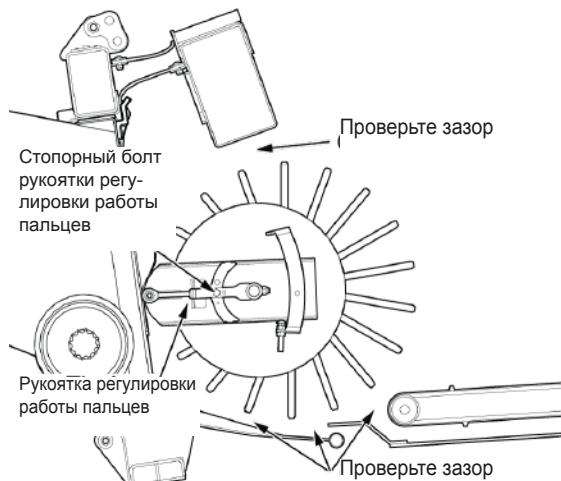
Рис. 245 - Расстояния между барабаном подающего шнека и другими элементами жатки
