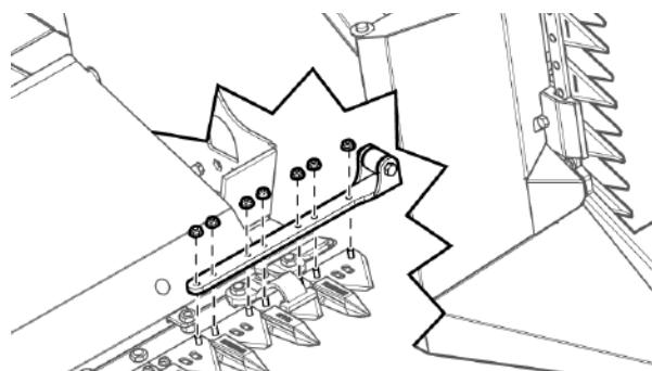
Рис. 87 - Установите головку ножа вертикальных ножниц
