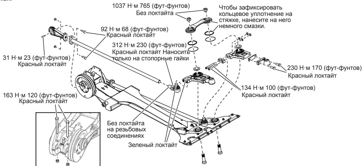
Рис. 209 - Рекомендуемые значения моментов затяжки компонентов привода ножей (подробные сведения см. в разделе 22.8 на стр. 161)
