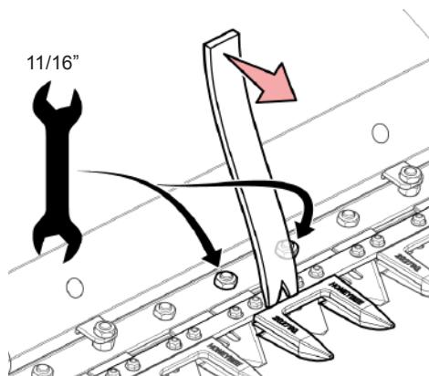
Рис. 215 - Смещайте ограждение вперед во время затяжки крепежных деталей
