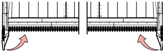
Рис. 90 - Ориентация вертикальных ножниц
