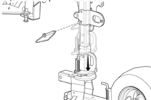
Рис. 275 - Опускание скобы сцепного стержня на ось сцепного стержня
