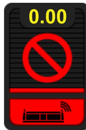
Рис. 140 - Предупреждение! Датчик высоты жатки не обнаружен!
