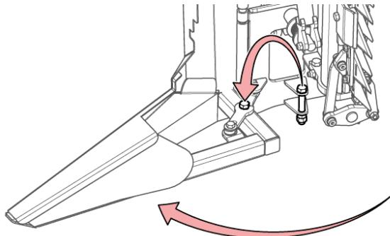
Рис. 93 - Зафиксируйте вертикальные ножницы в открытом положении
