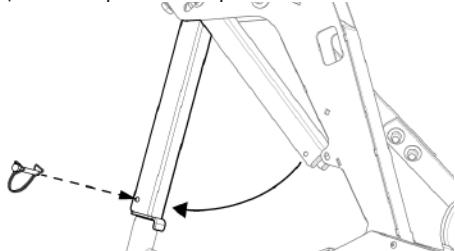
Рис. 187 - Ограничитель хода луча мотовила
