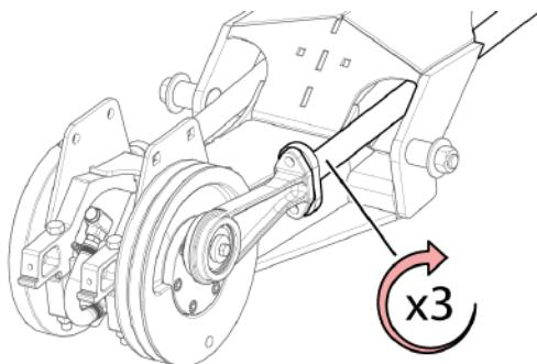
Рис. 211 - Затяните правый рычаг привода ножа на 3 оборота
