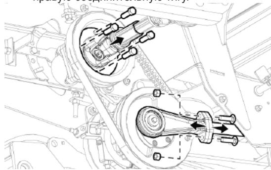
Рис. 158 - Отсоединение соединительной тяги и механизма отбора мощности.
