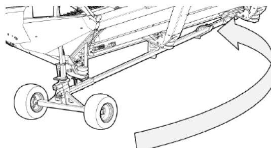
Рис. 279 - Поворот сцепного стержня в положение для хранения.
