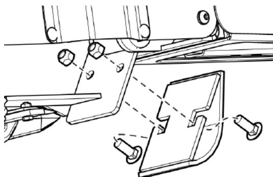
Рис. 242 - Снимите концевой кронштейн положка лопасти
