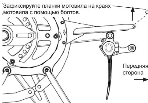
Рис. 43 - Поднятие пальцев мотовила в рабочее положение.
