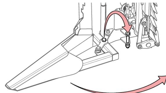
Рис. 97 - Закройте и зафиксируйте узел вертикальных ножниц
