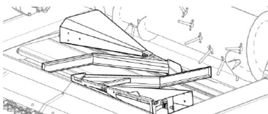
Рис. 271 - Размещение боковых делителей на центральном полотенном транспортере.
