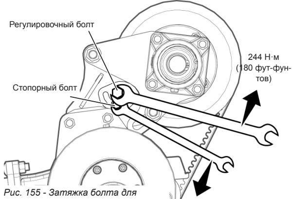
Рис. 155 - Затяжка болта для натяжения ремня.
