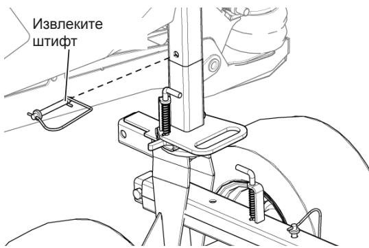
Рис. 48 - Извлечение штифта оси сцепного стержня
