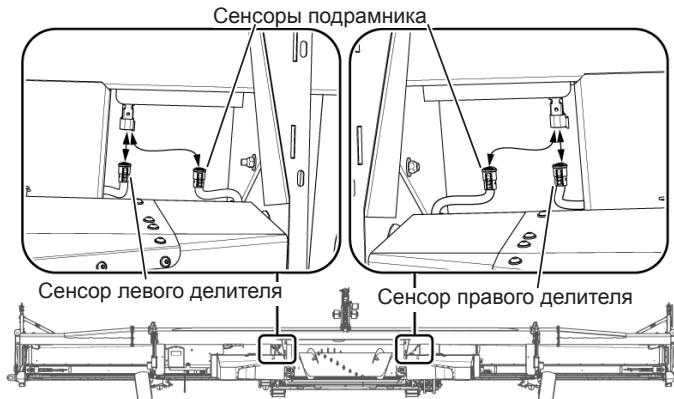
Рис. 117 - Выбор сенсоров при работе в режиме жесткой жатки
