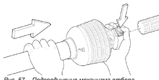
Рис. 57 - Подсоединение механизма отбора мощности.
