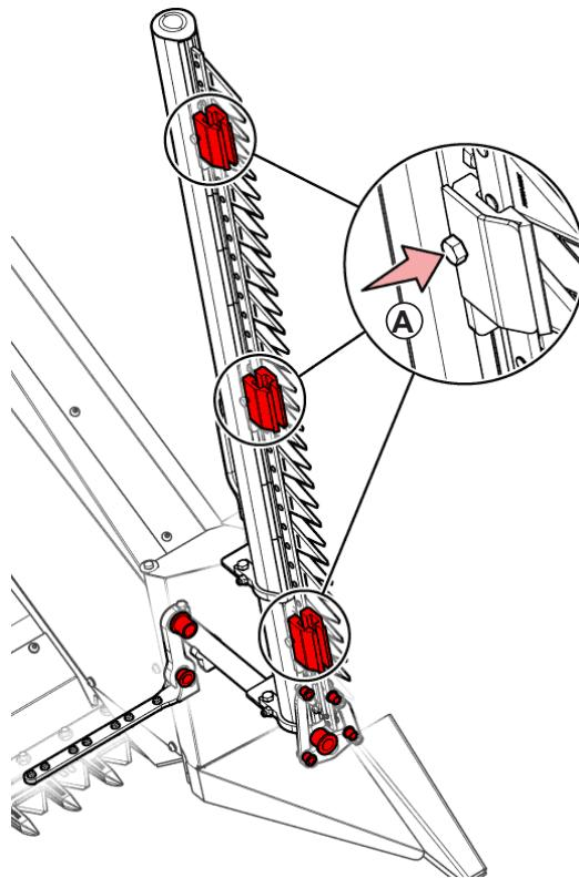
Рис. 84 - Места техобслуживания вертикальных ножниц.
