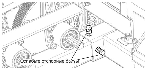
Рис. 161 - Стопорные болты первого приводного ремня левого полотенного транспортера.
