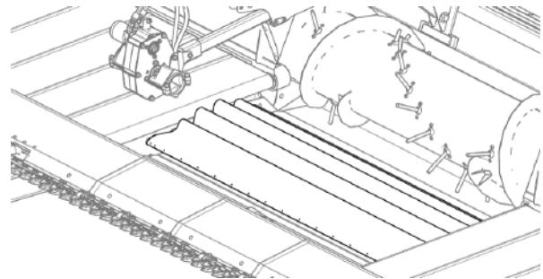
Рис. 183 - Развертывание нового полотенного транспортера на центральной деске.
