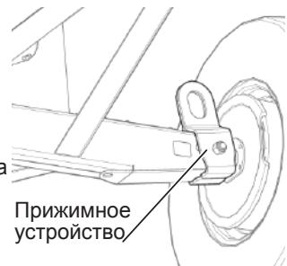
Рис. 280 - Прижимное устройство оси
