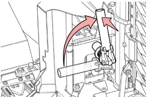
Рис. 96 - Зафиксируйте узел вертикальных ножниц с помощью стопорного рычага
