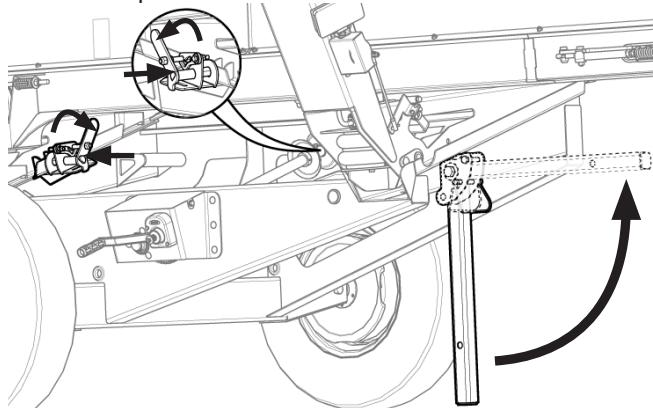
Рис. 274 - Прикрепление транспортной тележки к жатке.
