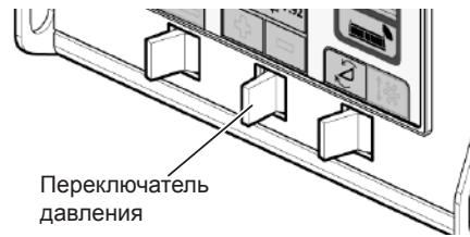
Рис. 114 - Установите давление воздуха до 25-65 фунтов на квадратный дюйм
