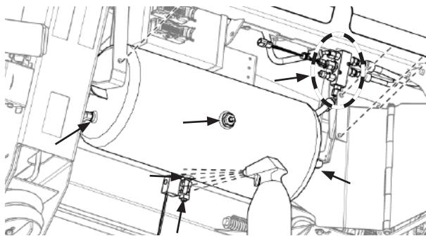
Рис. 264 - Проверка ресивера на предмет утечек.
