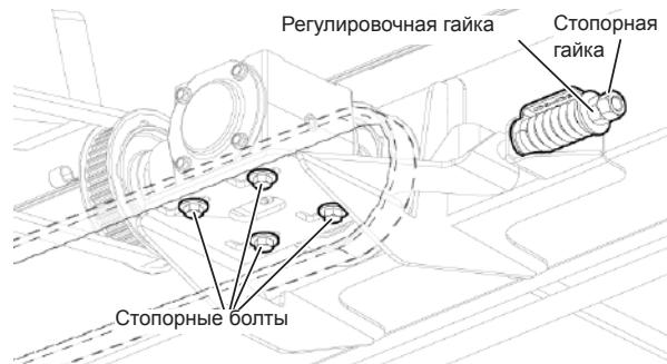
Рис. 170 - Регулировка натяжения второго ремня правого полотенного транспортера.
