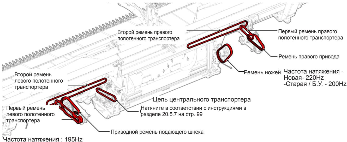
Рис. 144 - Места расположения приводных ремней
