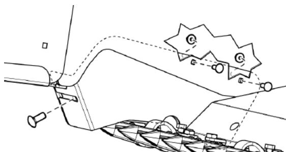
Рис. 243 - Установите привинчивающийся щиток
