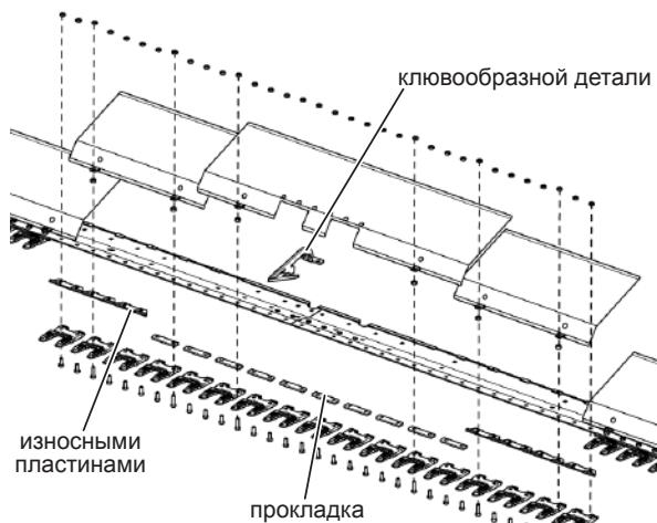
Рис. 214 - Компоновка низкопрофильной режущей системы
