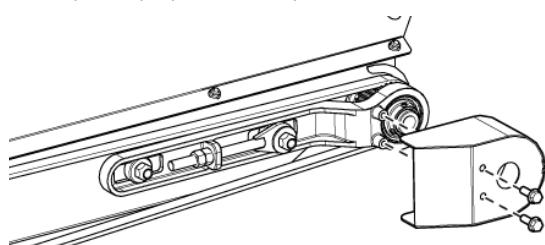
Рис. 165 - Снятие крышки приводного ремня левого полотенного транспортера.
