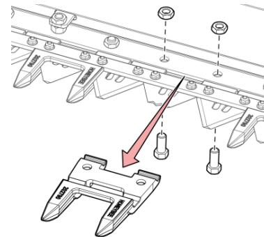
Рис. 227 - Снятие ограждения
