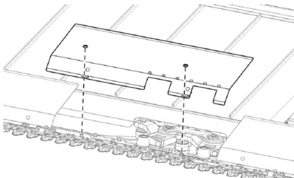
Рис. 217 - Снятие перьевой пластины, расположенной над подшипниками ножей.
