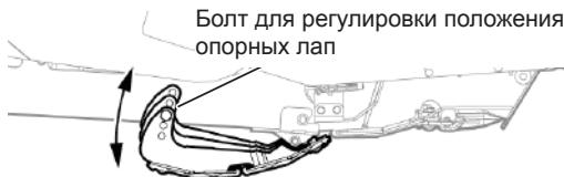
Рис. 73 - Два положения опорных лап
