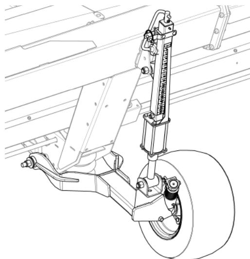
Рис. 38 - Опорное колесо.
