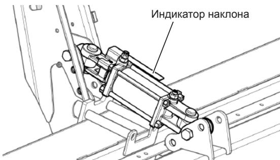
Рис. 101 - Гидравлический цилиндр и индикатор наклона
