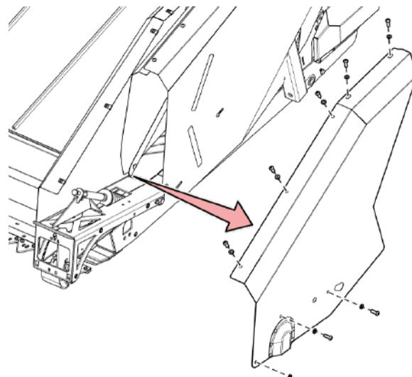
Рис. 86 - Снимите жестянную деталь
