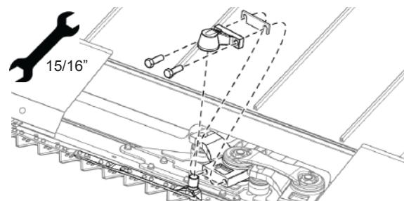
Рис. 220 - Снятие корпуса подшипников с головки правого ножа
