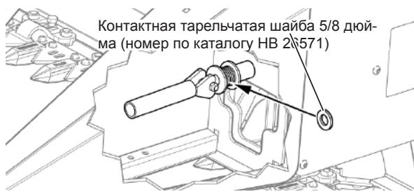
Рис. 237 - Установка дополнительной шайбы для закрепления расшатанной рукоятки.
