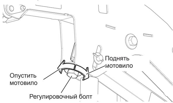
Рис. 66 - Болт для регулировки высоты мотовила.
