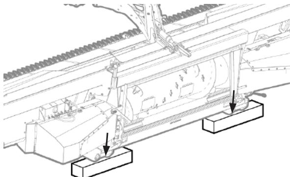
Рис. 282 - Установка жатки на блоки.
