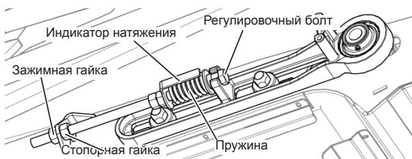
Рис. 176 - Настройка натяжения центрального полотенного транспортера
