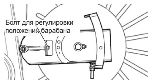
Рис. 246 - Положение барабана подающего шнека.
