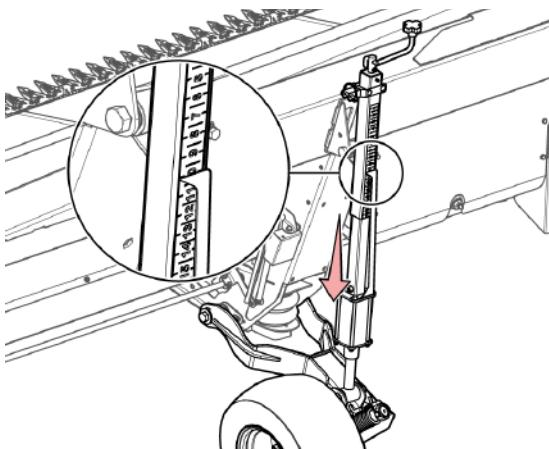
Рис. 64 - Настройте высоту опорного колеса.
