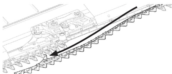
Рис. 224 - Подъем и вытягивание левого ножа.
