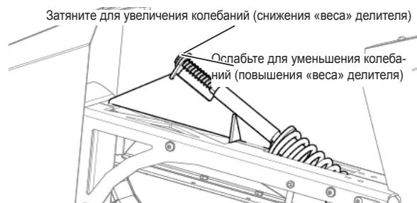
Рис. 241 - Регулировка параметров колебаний пружин боковых делителей.
