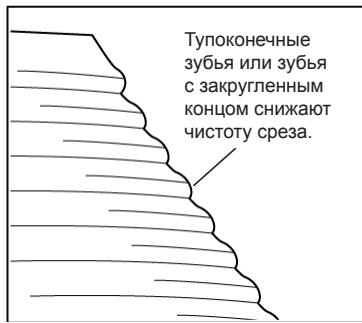
Рис. 226 - Износ режущего сегмента
