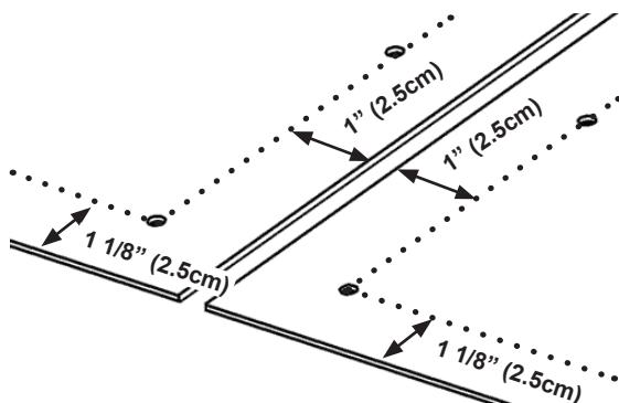
Рис. 185 - Положение отверстий для сращивания полотенного транспортера
