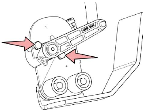
Рис. 261 - Регулировка сенсора делителей
