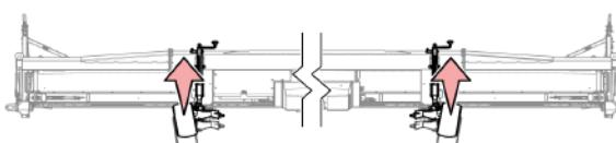
Рис. 112 - Поднятие опорных колес.
