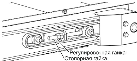
Рис. 175 - Регулировка натяжения центрального полотенного транспортера.
