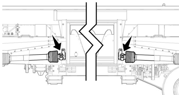
Рис. 281 - Положение приводных валов для хранения
