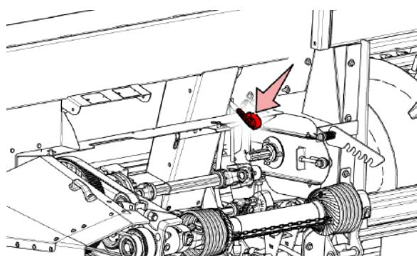
Рис. 262 - Расположение сенсора подрамника
