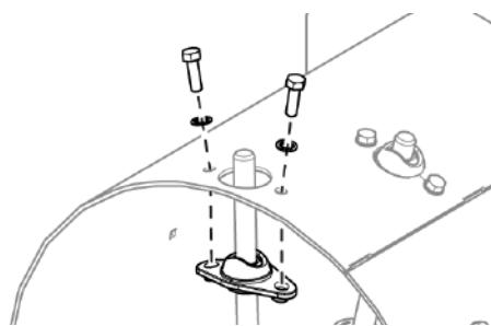
Рис. 249 - Замена направляющих устройств для пальцев подающего шнека.
