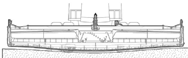
Рис. 111 - Режим гибкой жатки.
