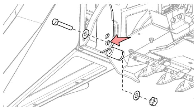
Рис. 92 - Зафиксируйте делитель
