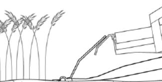
Рис. 115 - Слишком высокое давление воздуха в режиме гибкой жатки: режущий аппарат двигается над растениями.
