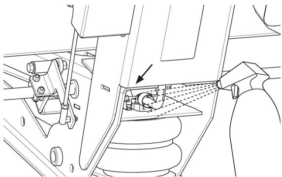
Рис. 266 - Проверка фитингов пневматических подушек на предмет утечек.
