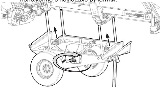
Рис. 273 - Установка транспортной тележки для жатки
