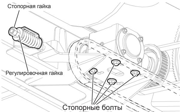
Рис. 149 - Регулировка натяжения второго приводного ремня левого полотенного транспортера.
