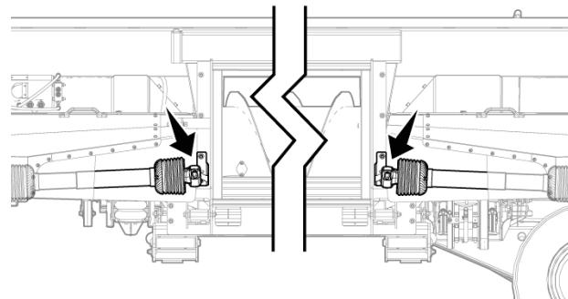
Рис. 284 - Положение приводных валов для хранения.
