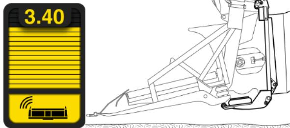
Рис. 136 - Панель оперативных данных - полный диапазон движения жатки доступен
