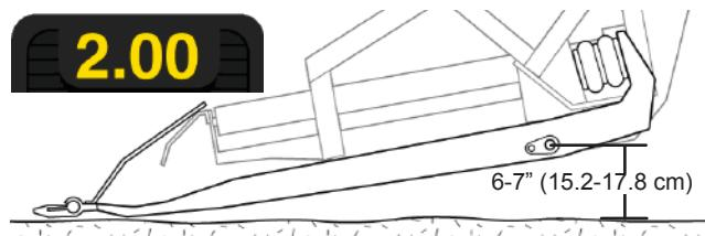
Рис. 60 - Оптимальный угол наклонной камеры.
