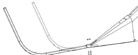
Рис. 238 - Трубная насадка для бокового делителя.
