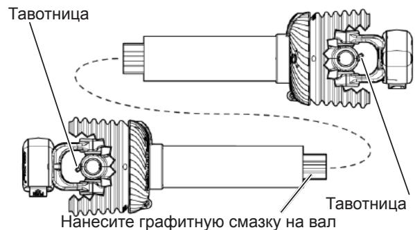
Рис. 255 - Точки нанесения смазки на приводной вал.
