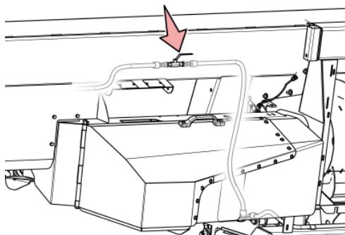
Рис. 122 - Клапан воздушного амортизатора подрамника
