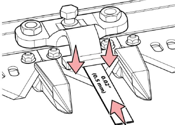
Рис. 231 - Надавите на режущую секцию и вставьте измерительный щуп
