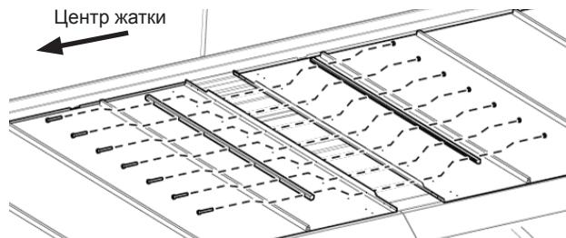
Рис. 177 - Установка соединительного стержня полотенного транспортера.
