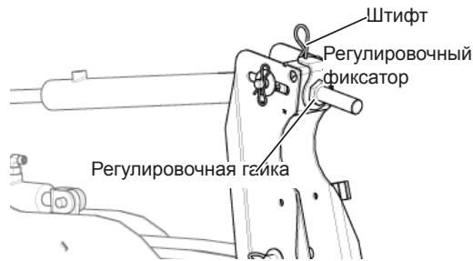
Рис. 192 - Регулировка высоты центрального луча мотовила.
