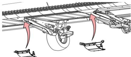
Рис. 74 - Опорные лапы – установленные в месте транспортной тележки
