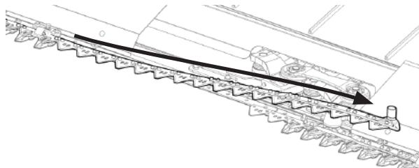
Рис. 221 - Подъем и вытягивание правого ножа
