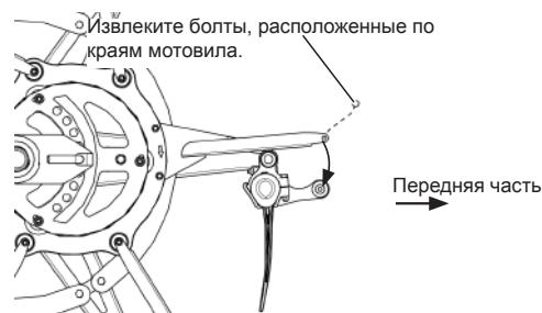
Рис. 272 - Опускание пальцев мотовила для транспортировки
