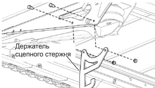
Рис. 46 - Снятие держателя сцепного стержня.
