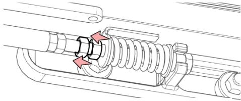
Рис. 178 - Ослабьте стопорные гайки
