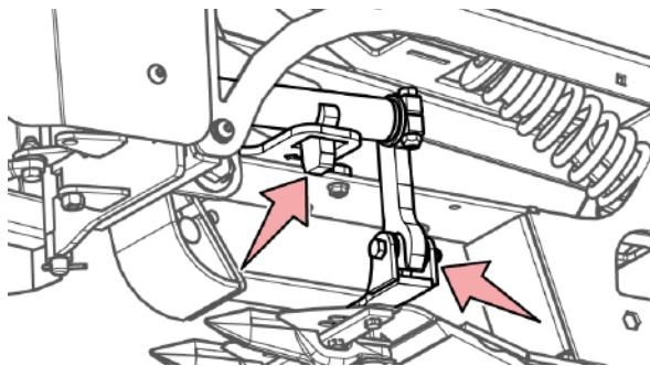
Рис. 95 - Выровняйте узел вертикальных ножниц
