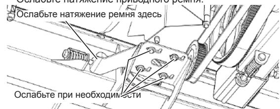
Рис. 164 - Ослабление натяжения приводного ремня левого полотенного транспортера.
