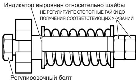
Рис. 143 - Положение индикатора натяжения.
