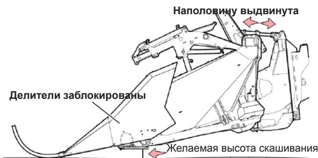
Рис. 120 - Установите высоту скашивания с помощью сенсоров подрамника
