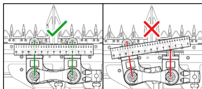
Рис. 208 - Расстояние отрегулировано правильно: угловые рычаги выровнены
