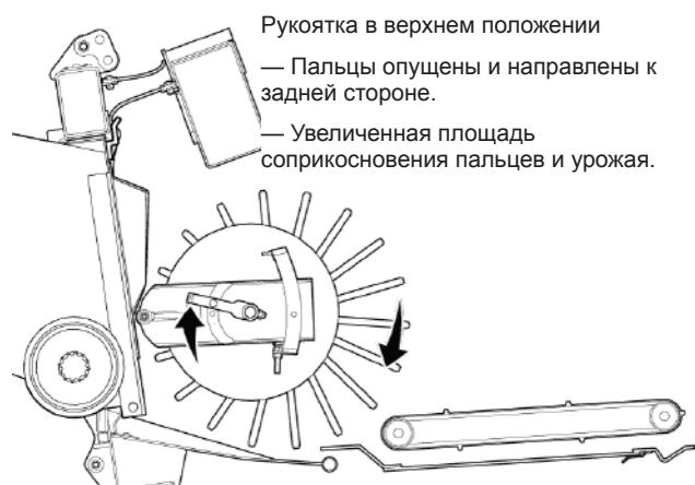
Рис. 71 - Пальцы барабана подающего шнека в нижнем положении
