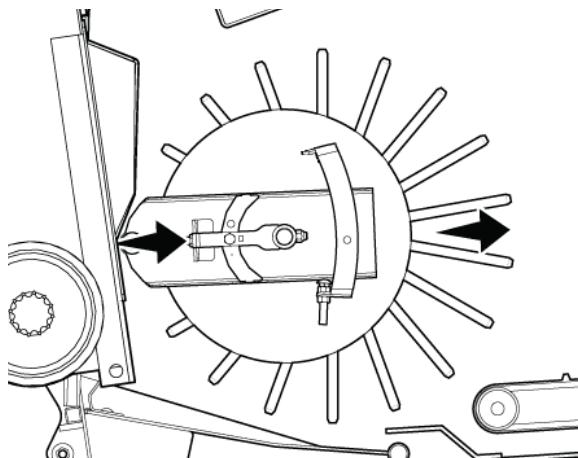
Рис. 125 - Пальцы подающего шнека в крайнем переднем положении.
