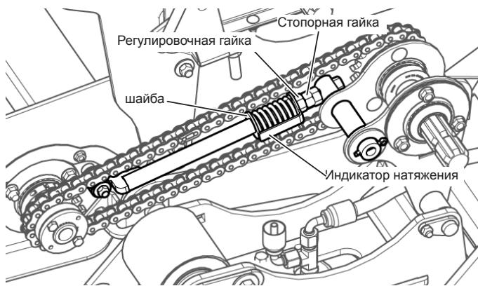
Рис. 150 - Регулировка натяжения приводной цепи центрального транспортера
