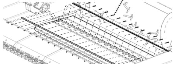
Рис. 184 - Закрепление полотенного транспортера с помощью соединительных стержней.
