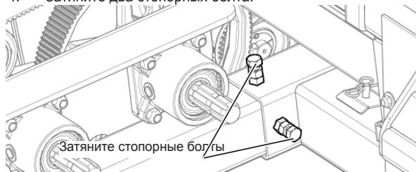
Рис. 163 - Стопорные болты первого приводного ремня левого полотенного транспортера.
