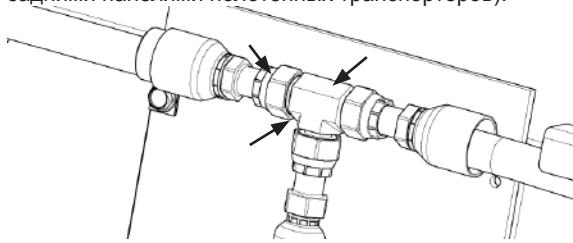
Рис. 265 - Проверка Т-образных фитингов, расположенных перед подкосами на предмет утечек
