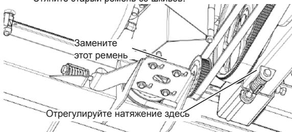
Рис. 162 - Снятие первого ремня левого полотенного транспортера.
