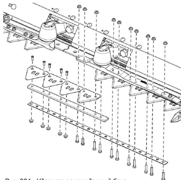
Рис. 234 - Удалите поврежденный брус перекрытия
