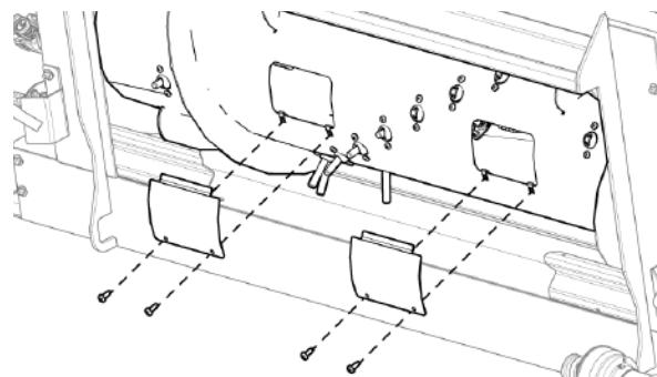
Рис. 247 - Доступ к внутренней части барабана подающего шнека
