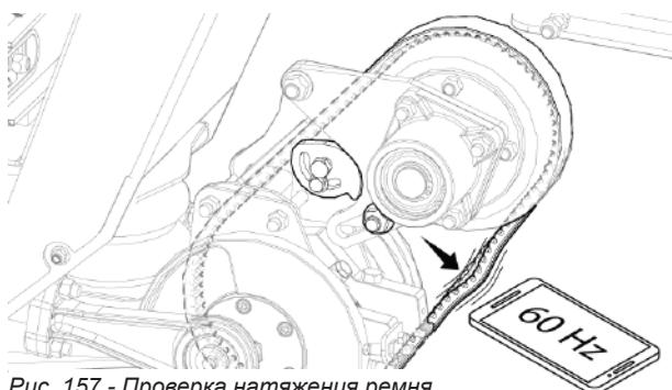
Рис. 157 - Проверка натяжения ремня
