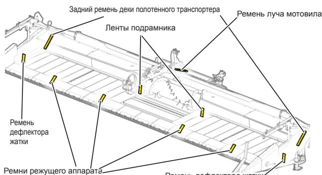
Рис. 41 - Места расположения поддерживающих ремней жатки AirFLEX
