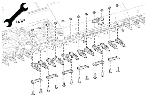
Рис. 222 - Снятие защитных устройств, которые окружают головку левого ножа
