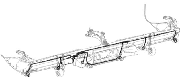
Рис. 98 - Пневматическая система жатки AirFLEX.
