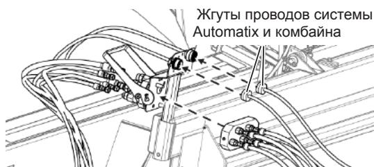
Рис. 53 - Подсоединение многоцелевого разъема и жгутов проводов.
