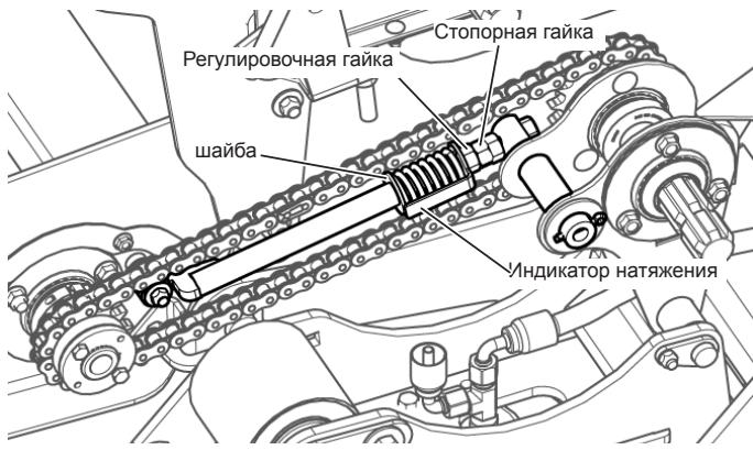
Рис. 167 - Регулировка натяжения приводной цепи центрального транспортера
