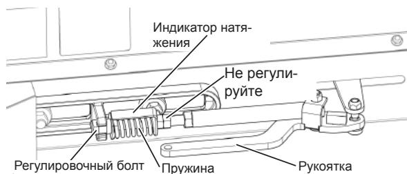
Рис. 171 - Регулировка натяжения полотенного транспортера
