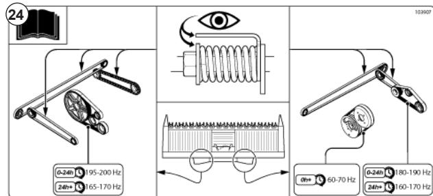
Рис. 27 - инструкции по натяжению конвейера
