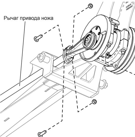
Рис. 210 - Отсоединения обеих ричагов привода ножа
