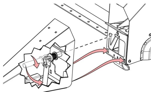
Рис. 45 - Установка бокового делителя с помощью опциональной рукоятки.
