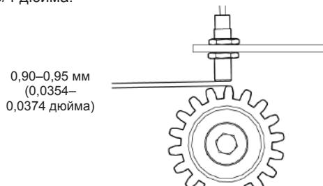
Рис. 189 - Регулировка сенсора скорости вращения мотовила.
