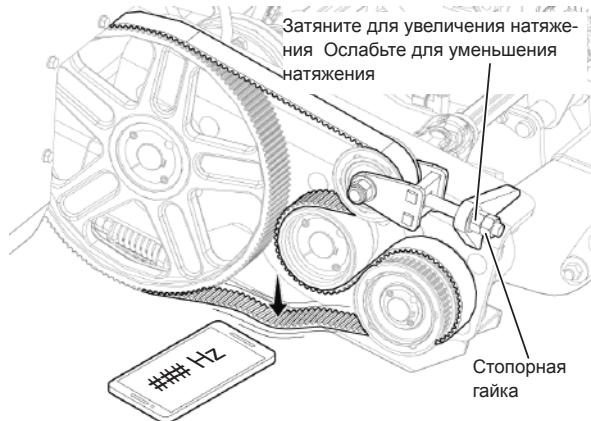
Рис. 147 - Натяжение приводного ремня подающего шнека.
