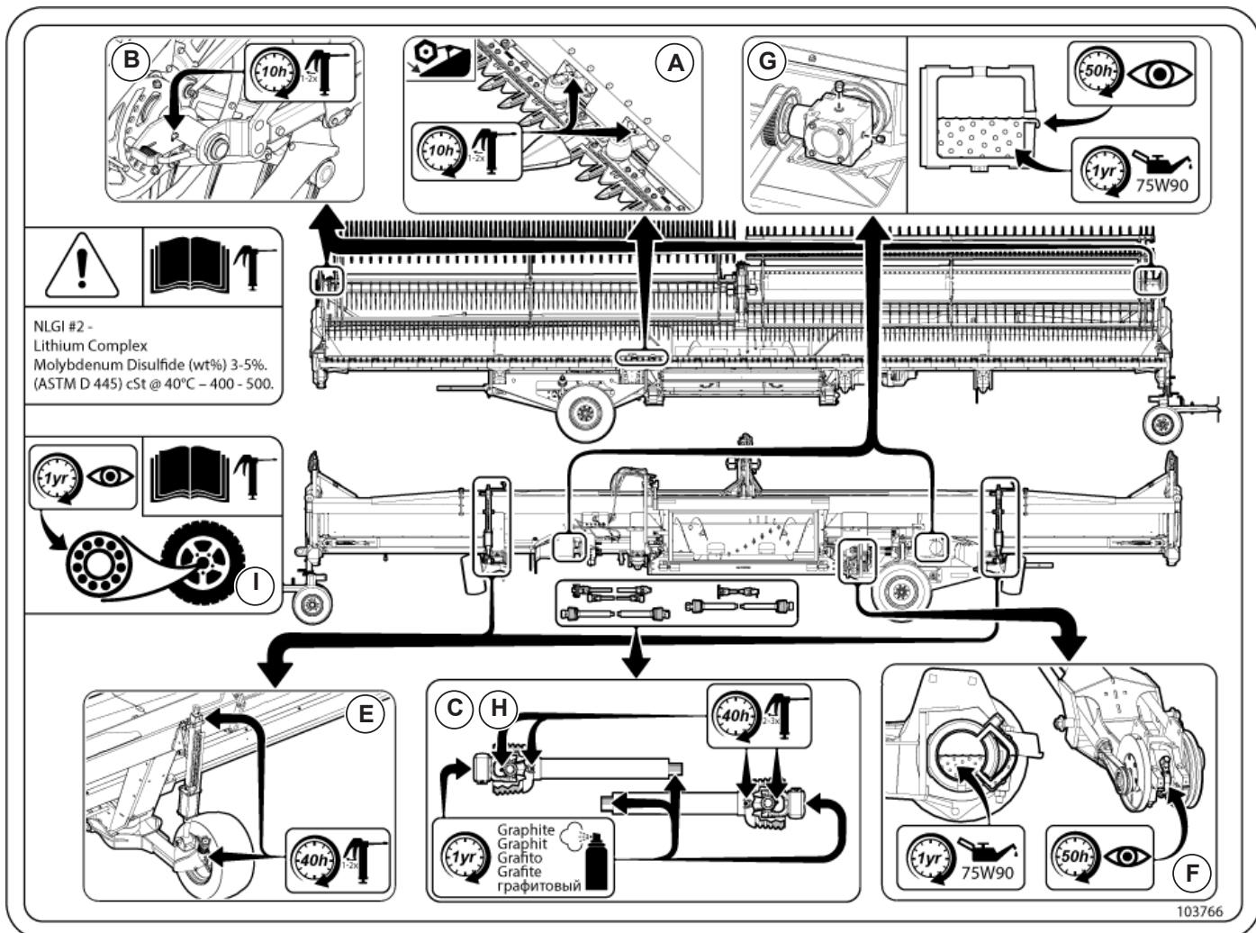
Рис. 268 - Места расположения точек нанесения смазки.
