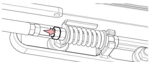
Рис. 181 - Затяните стопорную гайку
