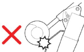
Рис. 78 - Воздействие консольного шнека на заднюю панель.
