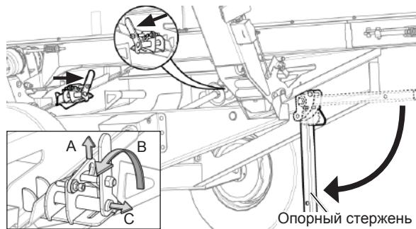
Рис. 49 - Разблокировка транспортного комплекта и опускание опорного стержня.
