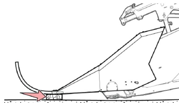
Рис. 63 - Деревянный блок, подложенный под делители.
