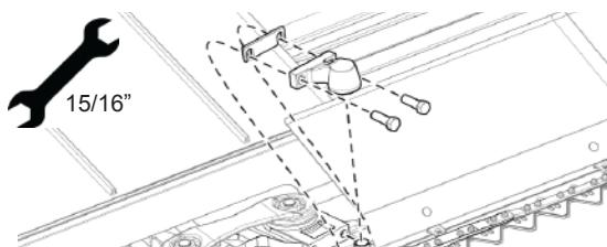
Рис. 223 - Снятие корпуса подшипников с головки левого ножа
