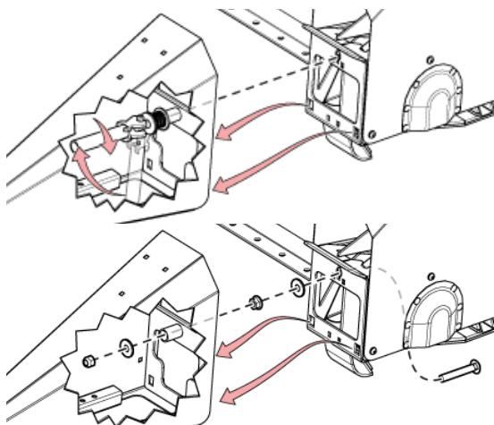
Рис. 85 - Снимите делители
