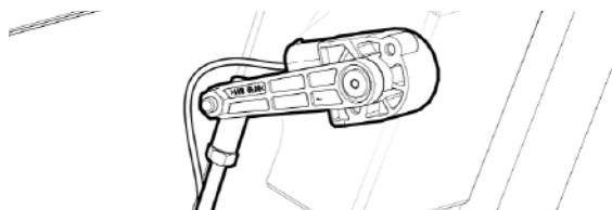
Рис. 258 - Выравнивание сенсоров высоты жатки в режиме гибкой жатки
