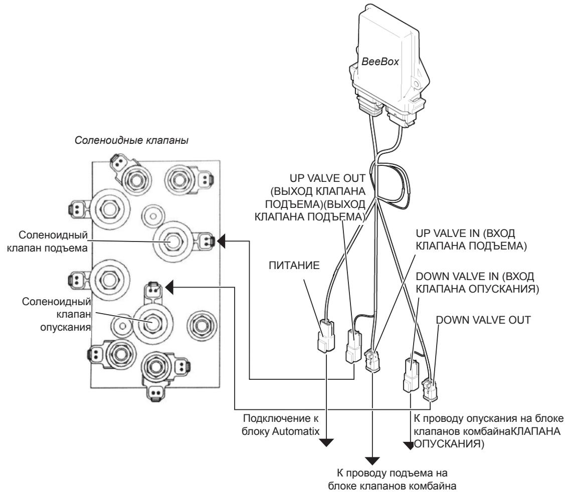
Рис. 298 - Устройство BeeBox, предназначенное для использования на комбайнах с двухпозиционными распределительными клапанами.
