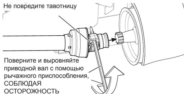
Рис. 56 - Установка приводных валов на обе стороны наклонной камеры.
