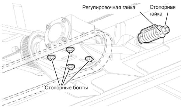
Рис. 153 - Регулировка натяжения второго ремня правого полотенного транспортера
