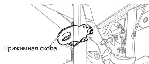
Рис. 47 - Снятие крепежной скобы
