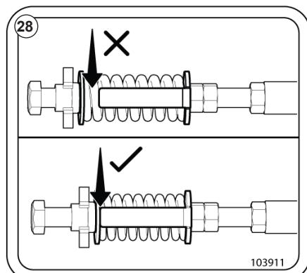
Рис. 31 - Натяжение и контроль движения полотенного транспортера.
