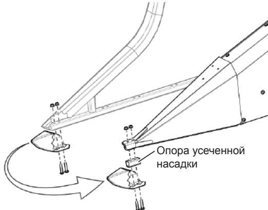
Рис. 240 - Усеченная насадка для бокового делителя.
