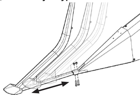
Рис. 239 - При возможных положениях насадки для бокового делителя
