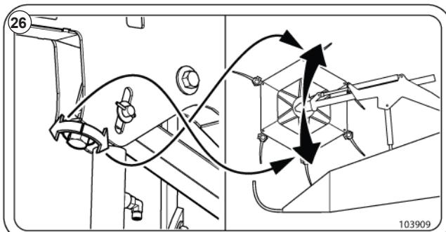
Рис. 29 - Инструкции по использованию лезвия мотовила.
