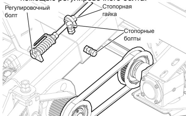
Рис. 169 - Снятие первого ремня правого полотенного транспортера для получения доступа к приводному ремню
