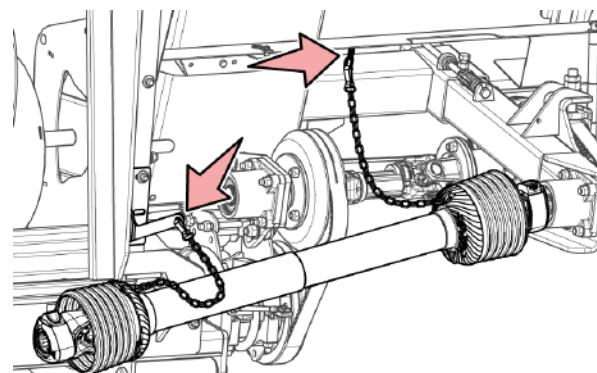
Рис. 58 - Закрепите щитки приводного вала.
