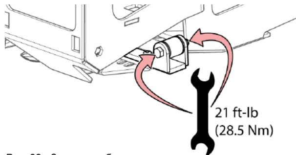
Рис. 88 - Затяните болт головки ножа
