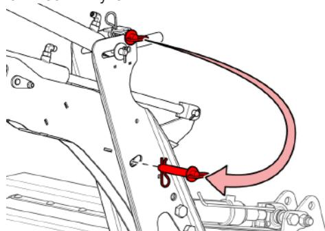
Рис. 188 - Стопорный штифт центрального луча мотовила
