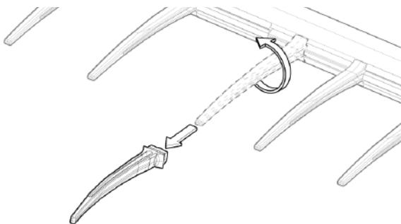
Рис. 194 - Извлечение пальца путем его поворота по часовой стрелке и вытягивания.
