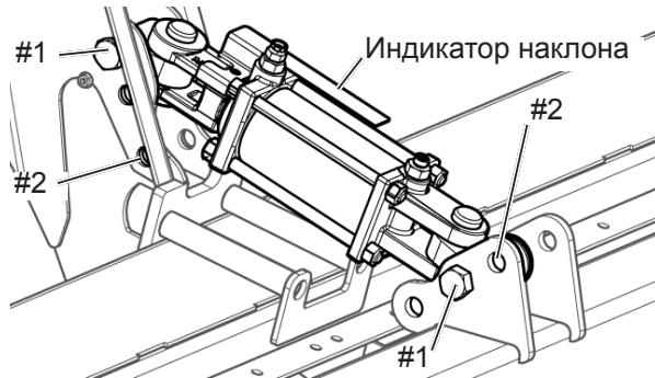
Рис. 251 - гидравлический цилиндр наклона
