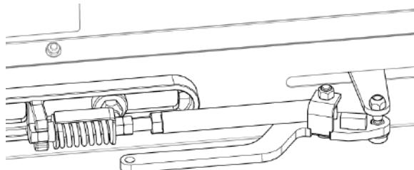
Рис. 99 - Правильное положение рукоятки натяжения полотенного транспортера.
