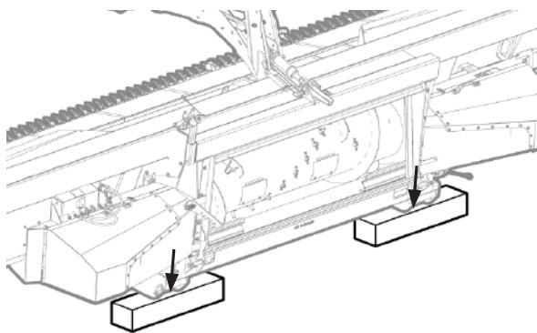
Рис. 283 - Установка жатки на блоки.
