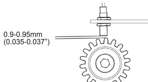
Рис. 141 - Расстояние от сенсора скорости до соответствующей поверхности.
