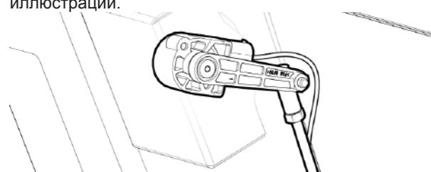
Рис. 256 - Выравнивание сенсора системы контроля высоты жатки.
