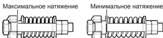
Рис. 172 - Положение индикатора натяжения
