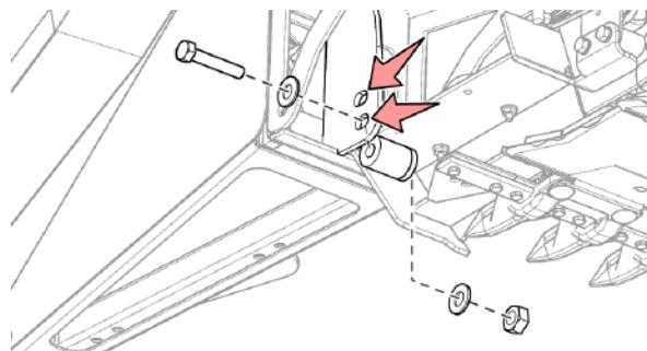
Рис. 235 - Блокировка делителей болтом
