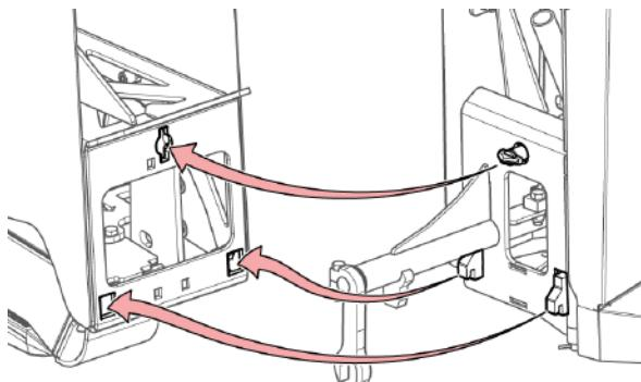
Рис. 94 - Установите узел вертикальных ножниц
