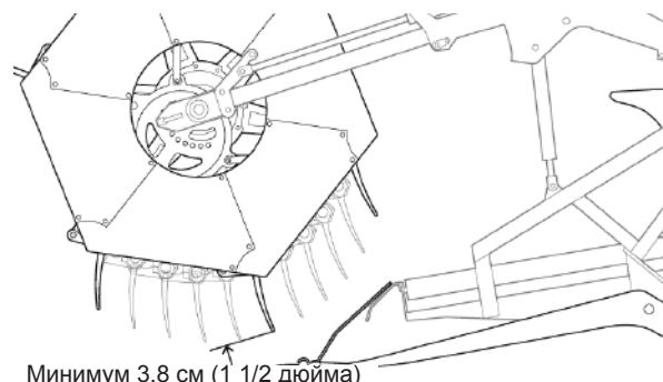
Рис. 68 - Расстояние между пальцами мотовила и режущим аппаратом.
