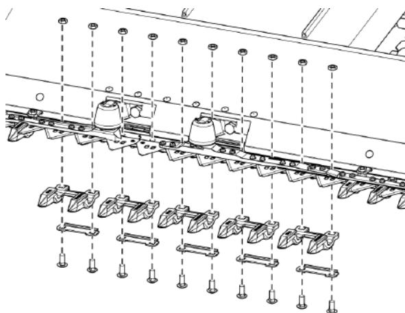
Рис. 233 - Снимите 5 пять центральных защитных щитков
