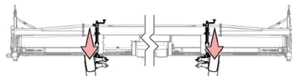
Рис. 124 - Опускайте опорные колеса до тех пор, пока они не коснутся почвы
