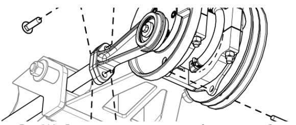
Рис. 206 - Выравнивание пластин привода с помощью болта.
