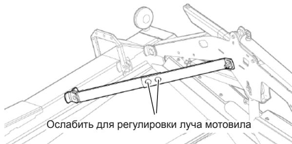
Рис. 69 - Выравнивание мотовила по центру
