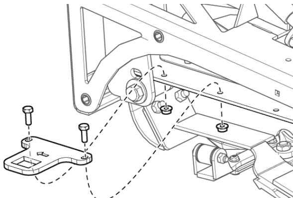
Рис. 89 - Установите стопорную пластину
