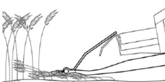
Рис. 116 - Слишком низкое давление воздуха в режиме гибкой жатки: защитные устройства зарываются в почву.
