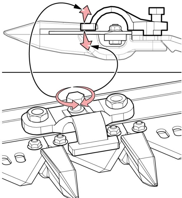
Рис. 232 - Регулировка держателя
