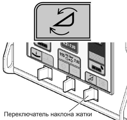
Рис. 100 - Активация режима наклона жатки
