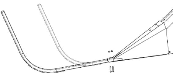
Рис. 108 - Трубная насадка для бокового делителя
