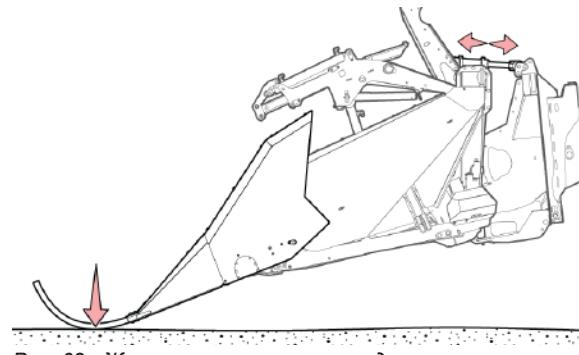
Рис. 62 - Жатка наклонена наружу, делители касаются земли
