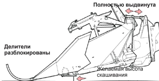
Рис. 123 - Установите высоту скашивания с помощью сенсоров делителей
