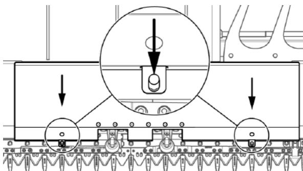
Рис. 213 - Пластина головки ножа
