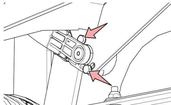
Рис. 263 - Регулировка сенсора подрамника
