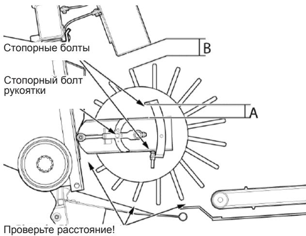
Рис. 72 - Расстояния между барабаном подающего шнека и другими компонентами оборудования.
