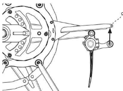
Рис. 42 - Поднимите планку мотовила в рабочее положение
