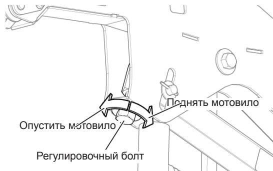
Рис. 191 - Болт для регулировки высоты мотовила.
