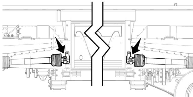
Рис. 276 - Положение приводных валов для хранения.
