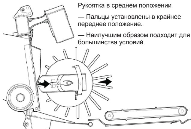
Рис. 70 - Пальцы барабана подающего шнека в среднем положении.
