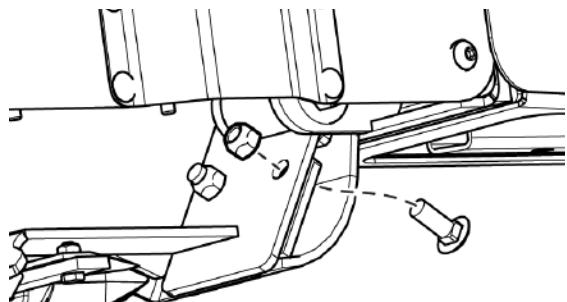
Рис. 244 - Установите концевой кронштейн положка лопасти
