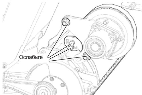
Рис. 159 - Ослабление стопорных механизмов.
