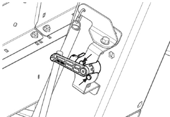
Рис. 259 - Регулировка сенсора контроля высоты жатки
