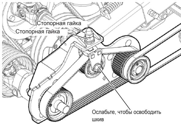
Рис. 166 - Регулировка натяжения первого ремня правого полотенного транспортера
