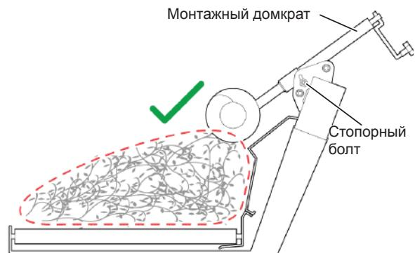
Рис. 77 - Регулировка расстояния между прижимным устройством и режущей секцией.
