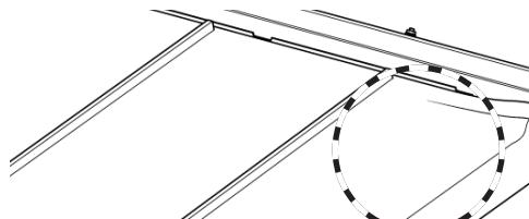
Рис. 173 - Неправильное натяжение полотенного транспортера
