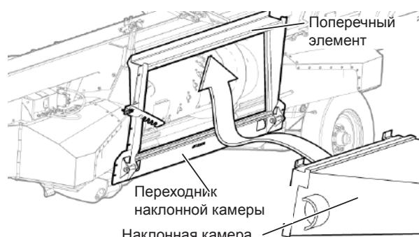
Рис. 51 - Ввод наклонной камеры в пластину переходника.
