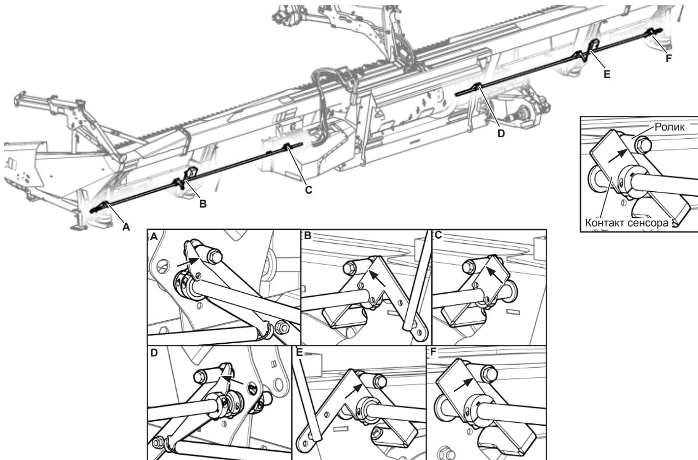
Рис. 257 - Места расположения контактов сенсоров системы контроля высоты гибкой жатки.
