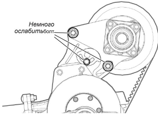
Рис. 154 - Натяжение ремня ножей: ослабление стопорной гайки и болта.
