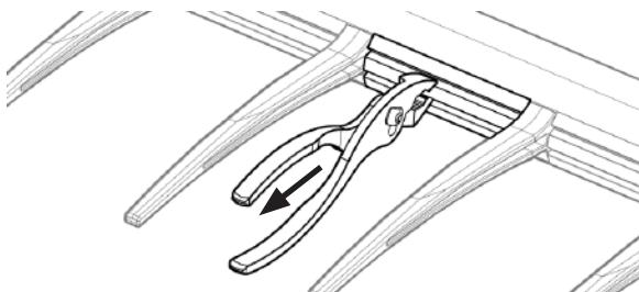
Рис. 193 - Извлечение распорной детали между пальцами мотовила.
