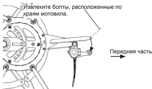
Рис. 255 - Опускание пальцев мотовила для транспортировки
