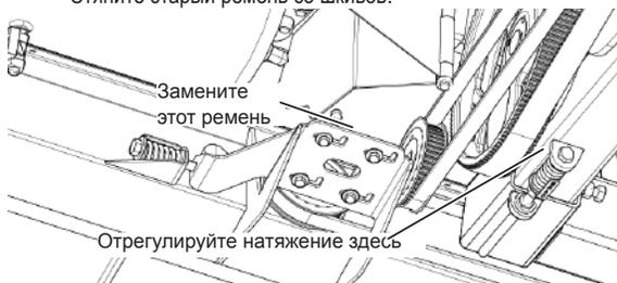
Рис. 148 - Снятие первого ремня левого полотенного транспортера.
