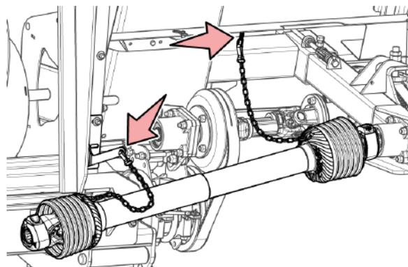
Рис. 58 - Закрепите щитки приводного вала.
