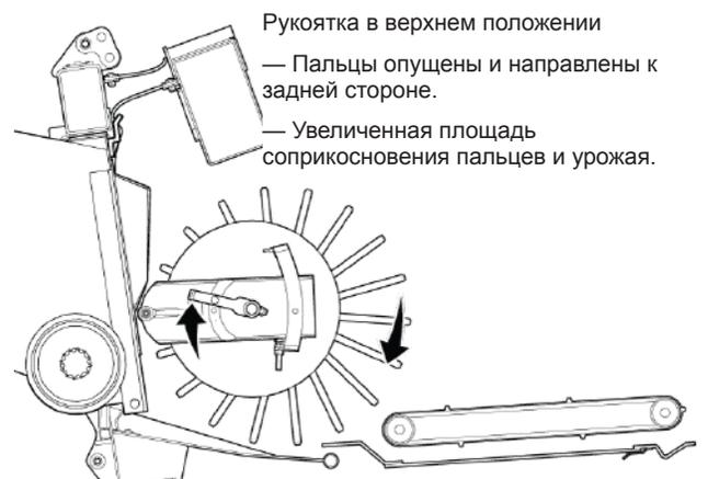
Рис. 71 - Пальцы барабана подающего шнека в нижнем положении
