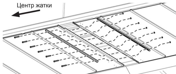
Рис. 163 - Установка соединительного стержня полотенного транспортера.
