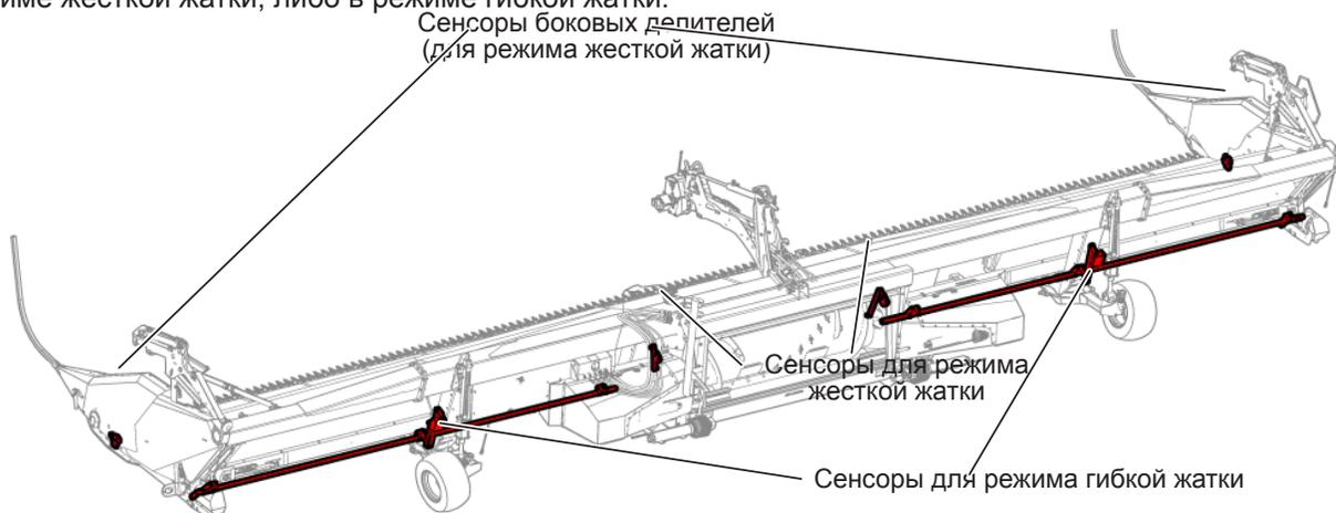
Рис. 278 - Места расположения сенсоров системы контроля высоты жатки.
