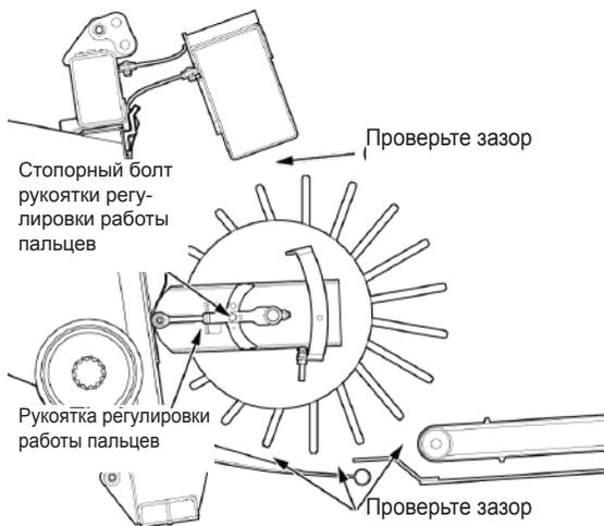
Рис. 228 - Расстояние между барабаном подающего шнека и другими элементами жатки
