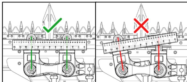
Рис. 194 - Расстояние отрегулировано правильно: угловые рычаги выровнены
