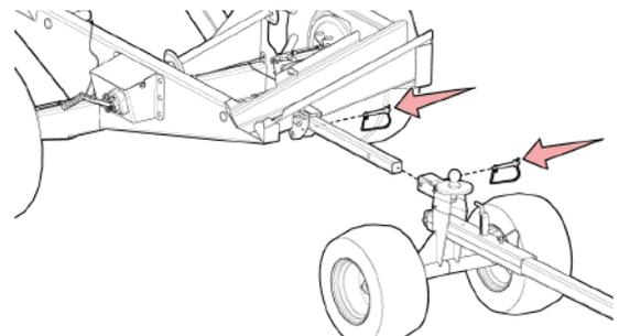
Рис. 50 - Положение транспортного комплекта для хранения.
