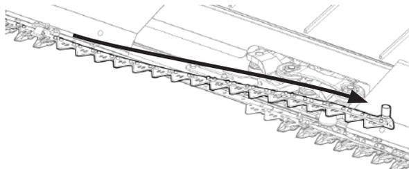
Рис. 207 - Подъем и вытягивание правого ножа
