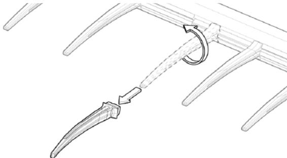
Рис. 180 - Извлечение пальца путем его поворота по часовой стрелке и вытягивания.
