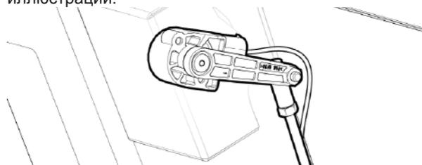
Рис. 239 - Выравнивание сенсора системы контроля высоты жатки.
