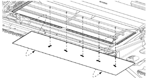
Рис. 168 - Снятие панели очистного люка центрального полотненного транспортера.
