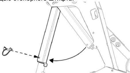
Рис. 173 - Ограничитель хода луча мотовила
