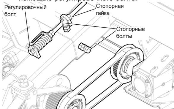
Рис. 155 - Снятие первого ремня правого полотенного транспортера для получения доступа к приводному ремню
