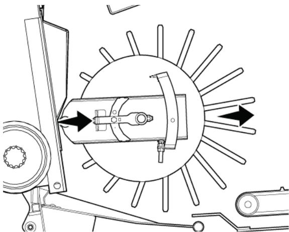
Рис. 111 - Пальцы подающего шнека в крайнем переднем положении.
