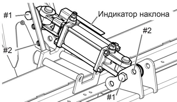
Рис. 234 - гидравлический цилиндр наклона
