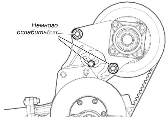
Рис. 140 - Натяжение ремня ножей: ослабление стопорной гайки и болта.
