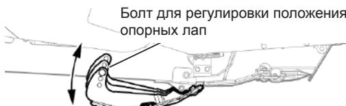
Рис. 73 - Два положения опорных лап
