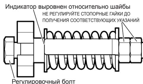
Рис. 129 - Положение индикатора натяжения.
