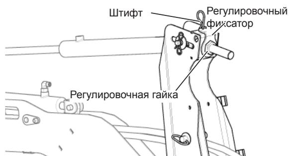
Рис. 67 - Регулировка высоты центрального луча мотовила.
