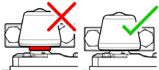
Рис. 211 - Проверка правильности установки корпуса подшипников
