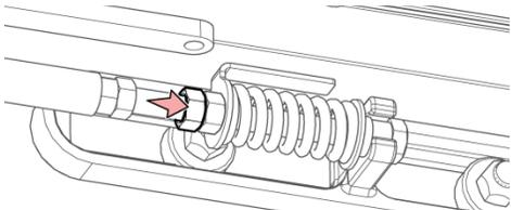
Рис. 167 - Затяните стопорную гайку
