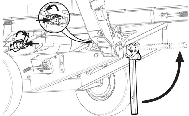
Рис. 257 - Прикрепление транспортной тележки к жатке.
