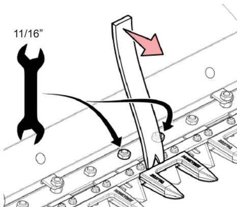
Рис. 201 - Смещайте ограждение вперед во время затяжки крепежных деталей
