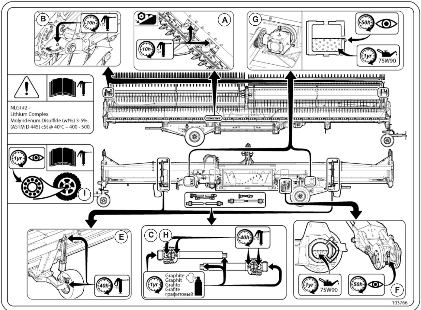
Рис. 251 - Места расположения точек нанесения смазки.
