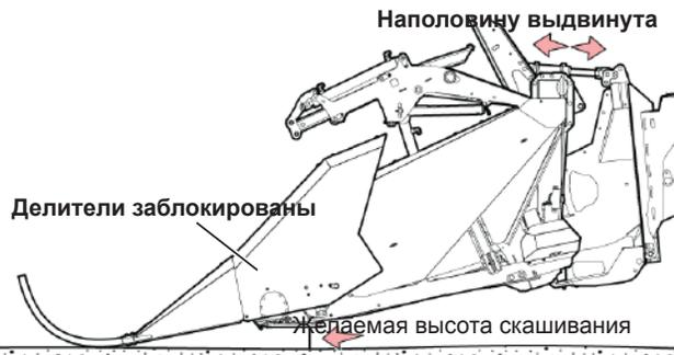
Рис. 106 - Установите высоту скашивания с помощью сенсоров подрамника
