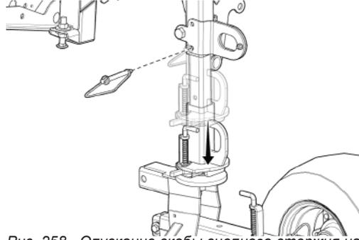
Рис. 258 - Опускание скобы сцепного стержня на ось сцепного стержня
