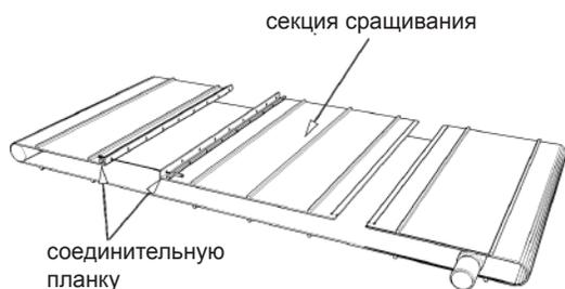
Рис. 172 - сращивания полотенного транспортера
