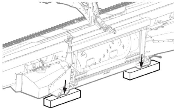
Рис. 265 - Установка жатки на блоки.
