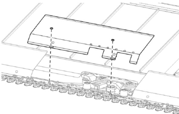
Рис. 203 - Снятие перьевой пластины, расположенной над подшипниками ножей.
