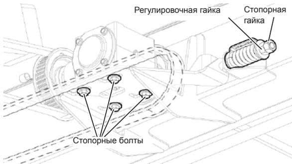
Рис. 139 - Регулировка натяжения второго ремня правого полотненного транспортера
