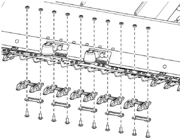
Рис. 219 - Снимите 5 пять центральных защитных щитков
