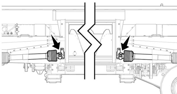
Рис. 264 - Положение приводных валов для хранения
