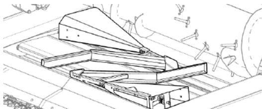
Рис. 254 - Размещение боковых делителей на центральном полотенном транспортере.
