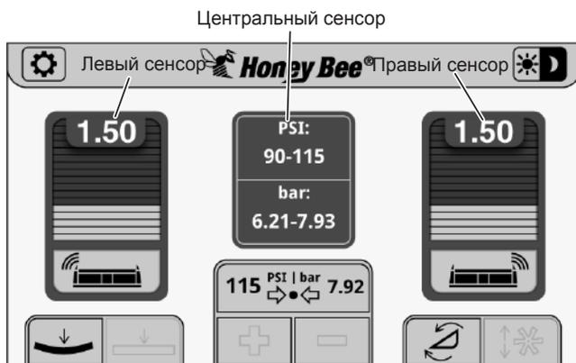
Рис. 279 - Идентификация сенсоров системы контроля высоты жатки на дисплее Automatrix.
