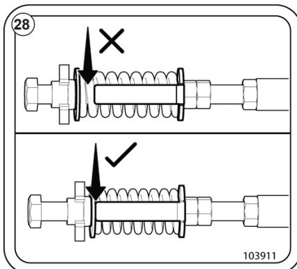
Рис. 31 - Натяжение и контроль движения полотненного транспортера.
