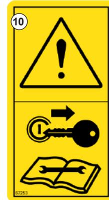
Рис. 13 - Для технического обслуживания выключите двигатель.
