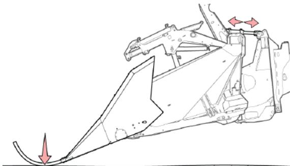
Рис. 62 - Жатка наклонена наружу, делители касаются земли
