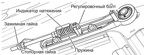
Рис. 162 - Настройка натяжения центрального полотенного транспортера
