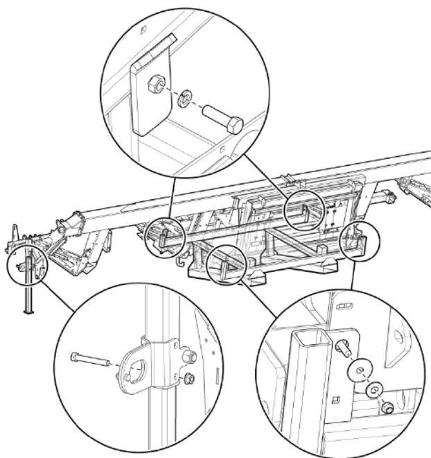
Рис. 52 - Отсоединение подъемной рамы
