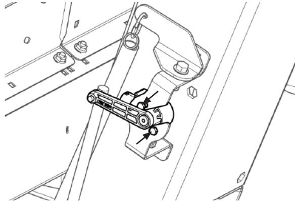
Рис. 242 - Регулировка сенсора контроля высоты жатки
