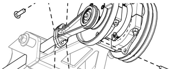
Рис. 192 - Выравнивание пластин привода с помощью болта.
