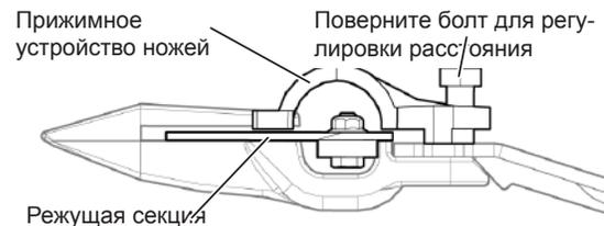
Рис. 81 - Регулировка расстояния между прижимным устройством и режущей секцией
