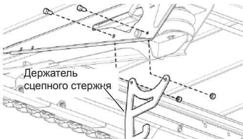
Рис. 46 - Снятие держателя сцепного стержня.
