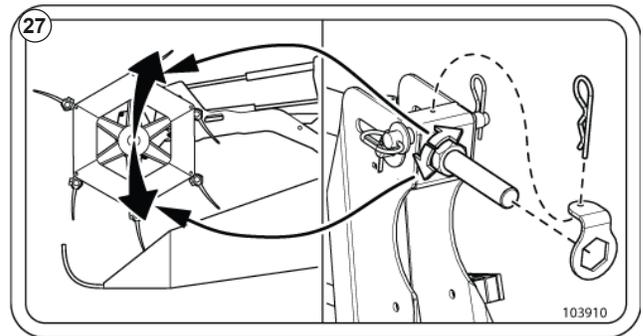
Рис. 30 - Инструкции по использованию центрального луча мотовила.
