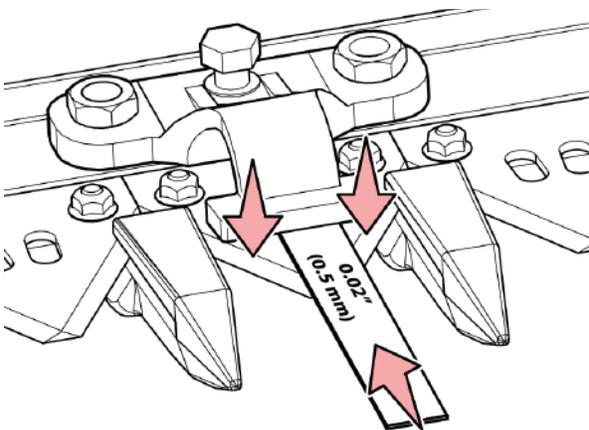
Рис. 217 - Надавите на режущую секцию и вставьте измерительный щуп
