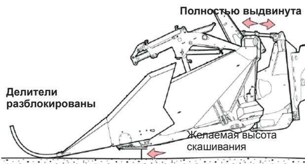
Рис. 109 - Установите высоту скашивания с помощью сенсоров делителей
