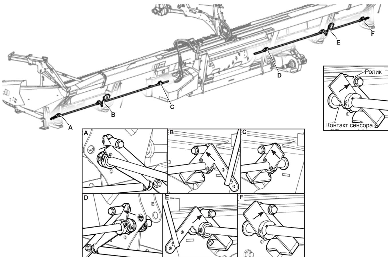
Рис. 240 - Места расположения контактов сенсоров системы контроля высоты гибкой жатки.
