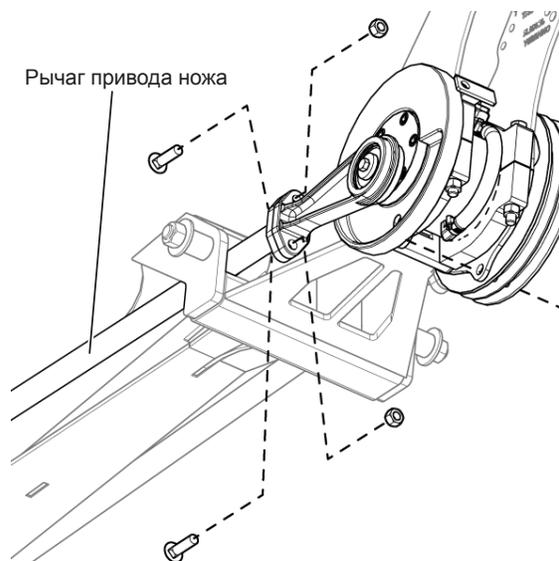
Рис. 196 - Отсоединения обеих рычагов привода ножа
