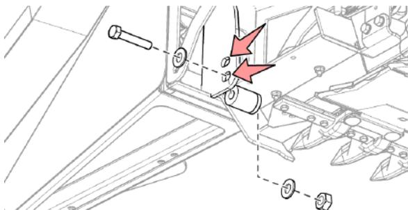
Рис. 221 - Блокировка делителей болтом
