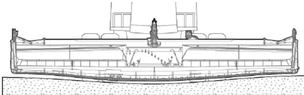
Рис. 97 - Режим гибкой жатки.
