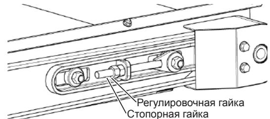
Рис. 161 - Регулировка натяжения центрального полотенного транспортера.
