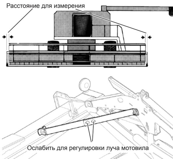
Рис. 69 - Выравнивание мотовила по центру
