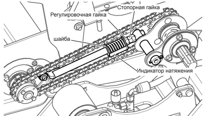
Рис. 153 - Регулировка натяжения приводной цепи центрального транспортера
