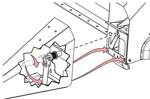
Рис. 45 - Установка бокового делителя с помощью опциональной рукоятки.
