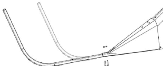
Рис. 224 - Трубная насадка для бокового делителя.
