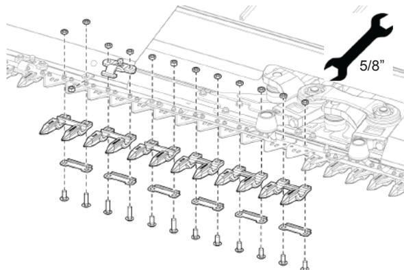
Рис. 205 - Снятие защитных устройств, которые окружают головку правого ножа
