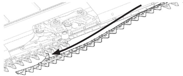
Рис. 210 - Подъем и вытягивание левого ножа.
