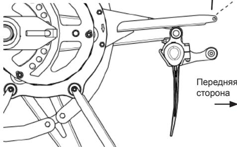
Рис. 43 - Поднятие пальцев мотовила в рабочее положение.
