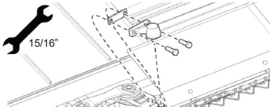
Рис. 209 - Снятие корпуса подшипников с головки левого ножа
