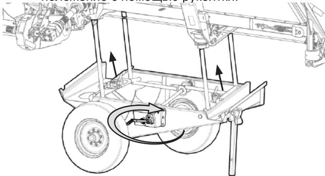
Рис. 256 - Установка транспортной тележки для жатки
