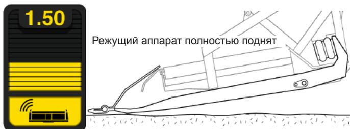
Режущий аппарат полностью поднят
