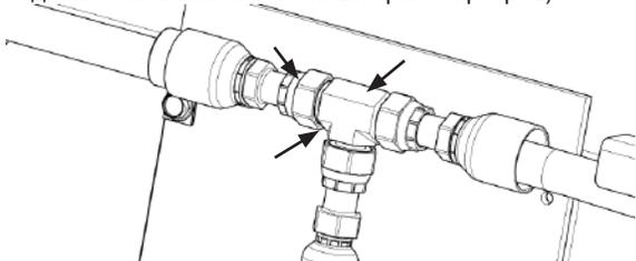
Рис. 248 - Проверка Т-образных фитингов, расположенных перед подкосами на предмет утечек
