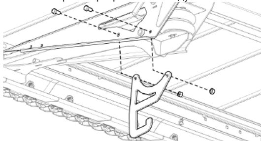
Рис. 261 - Держатель сцепного стержня.
