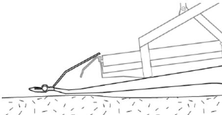
Рис. 59 - Режущий аппарат поднят.
