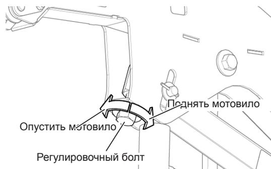
Рис. 177 - Болт для регулировки высоты мотовила.
