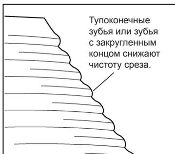
Рис. 212 - Износ режущего сегмента
