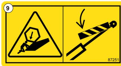
Рис. 12 - Перед проведением технического обслуживания установите фиксатор мотовила.
