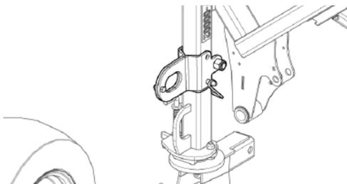
Рис. 260 - Проверка устройства оси стержня.
