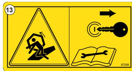
Рис. 16 - Для технического обслуживания мотовила выключите двигатель.
