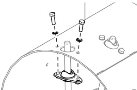
Рис. 232 - Замена направляющих устройств для пальцев подающего шнека.
