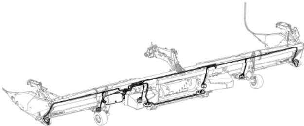
Рис. 84 - Пневматическая система жатки AirFLEX.
