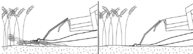
Рис. 102 - Слишком низкое давление воздуха в режиме гибкой жатки: защитные устройства зарываются в почву. Рис. 101 - Слишком высокое давление воздуха в режиме гибкой жатки: режущий аппарат двигается над растениями.
