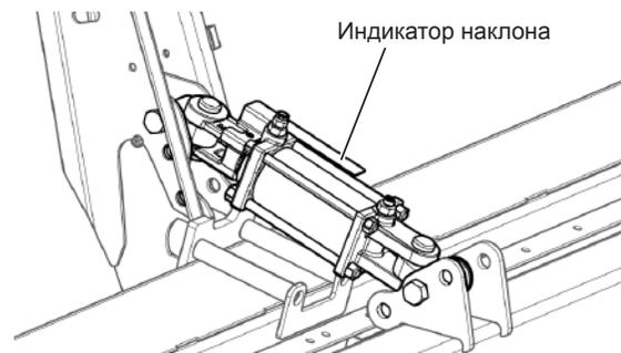
Рис. 87 - Гидравлический цилиндр и индикатор наклона
