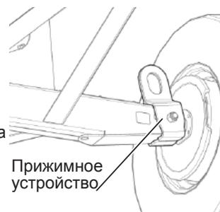
Рис. 263 - Прижимное устройство оси
