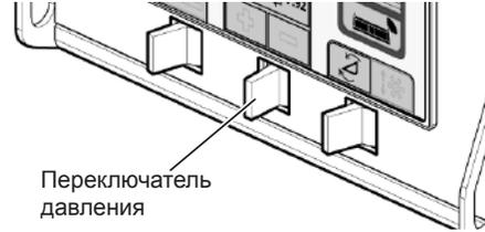
Рис. 100 - Установите давление воздуха до 25-65 фунтов на квадратный дюйм
