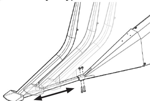
Рис. 225 - При возможных положения насадки для бокового делителя
