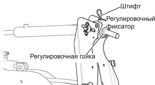
Рис. 178 - Регулировка высоты центрального луча мотовила.
