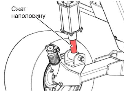
Рис. 107 - Опорное колесо сжато наполовину
