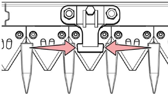
Рис. 216 - Выровняйте секцию режущей кромки на держателе
