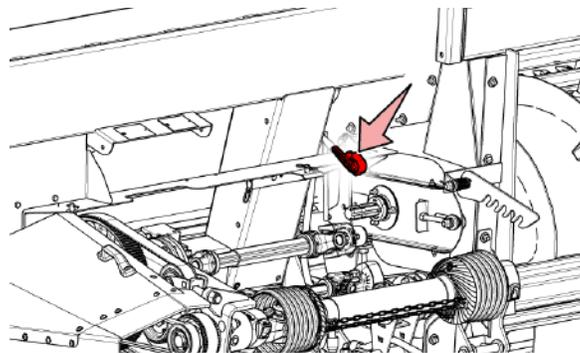
Рис. 245 - Расположение сенсора подрамника
