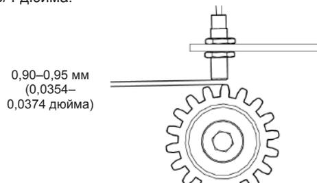
Рис. 175 - Регулировка сенсора скорости вращения мотовила.
