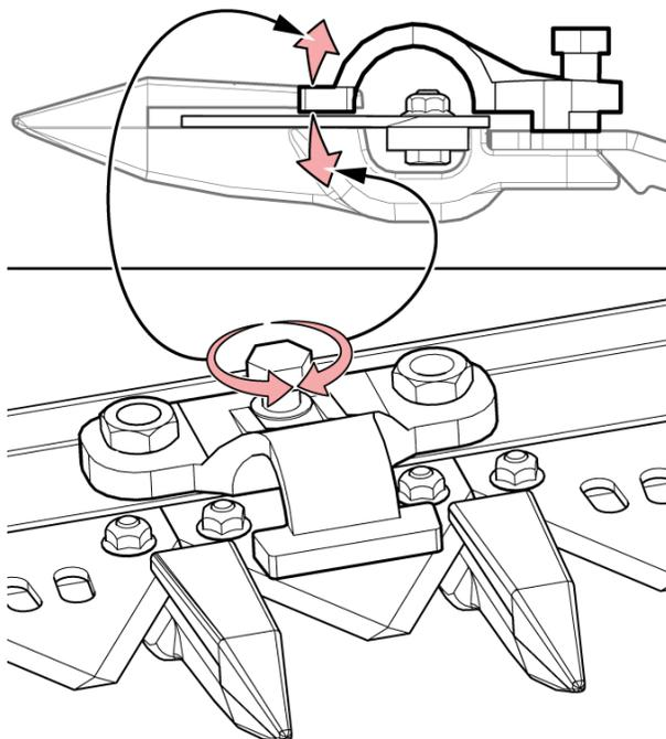
Рис. 218 - Регулировка держателя
