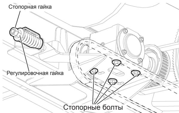
Рис. 135 - Регулировка натяжения второго приводного ремня левого полотненного транспортера.
