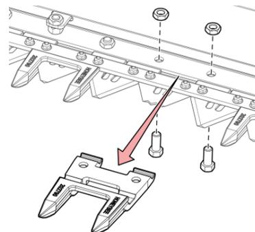
Рис. 213 - Снятие ограждения
