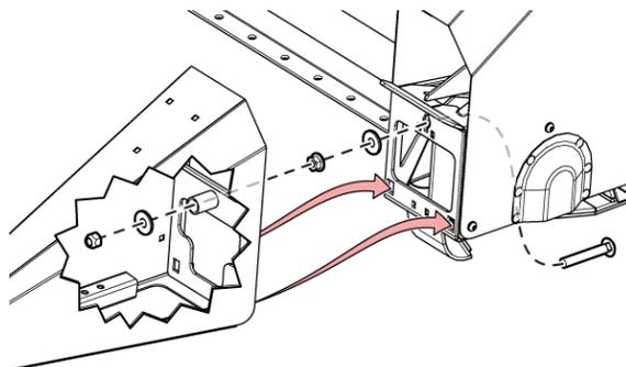
Рис. 44 - Установка бокового делителя.
