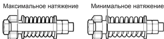
Рис. 158 - Положение индикатора натяжения
