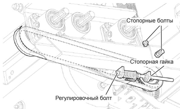
Рис. 134 - Регулировка натяжения первого приводного ремня левого полотненного транспортера.
