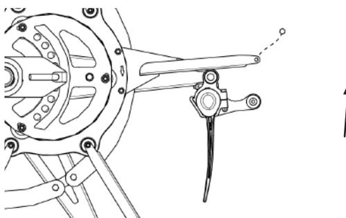
*Рис. 42 - Поднимите планку мотовила в рабочее положение*
