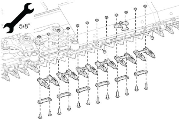
Рис. 208 - Снятие защитных устройств, которые окружают головку левого ножа
