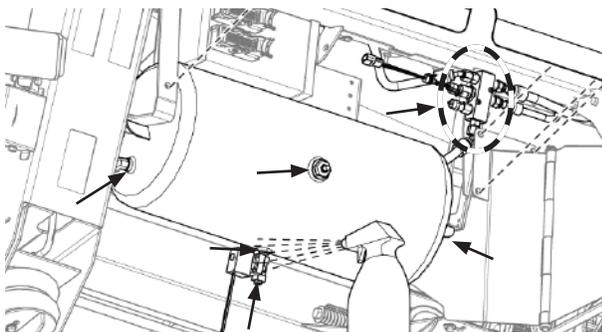
Рис. 247 - Проверка ресивера на предмет утечек.
