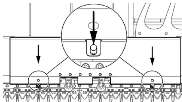
Рис. 199 - Пластина головки ножа
