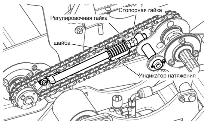
Рис. 136 - Регулировка натяжения приводной цепи центрального транспортера
