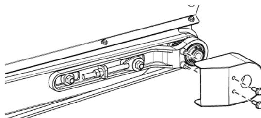
Рис. 151 - Снятие крышки приводного ремня левого полотенного транспортера.
