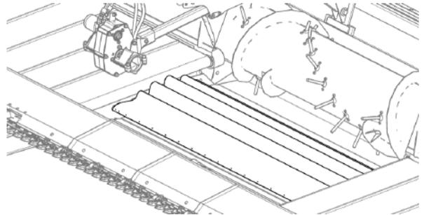
Рис. 169 - Развертывание нового полотненного транспортера на центральной деке.
