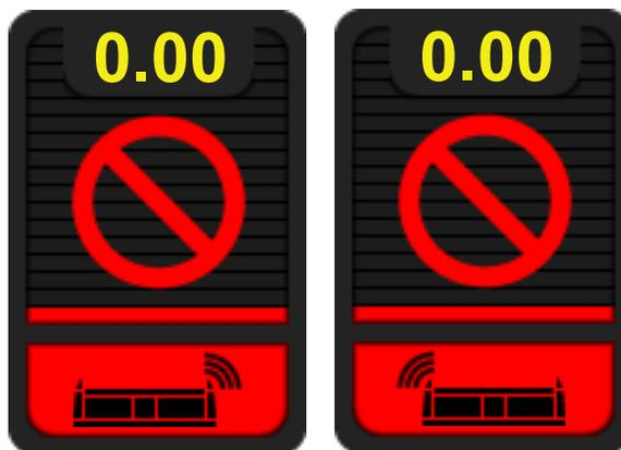
Рис. 126 - Предупреждение! Датчик высоты жатки не обнаружен!
