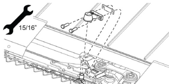
Рис. 206 - Снятие корпуса подшипников с головки правого ножа
