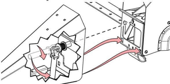
Рис. 222 - Дополнительная рукоятка делителя.
