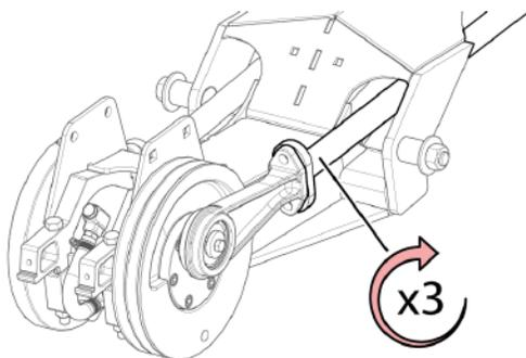
Рис. 197 - Затяните правый рычаг привода ножа на 3 оборота
