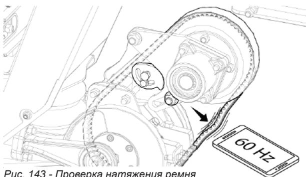
Рис. 143 - Проверка натяжения ремня
