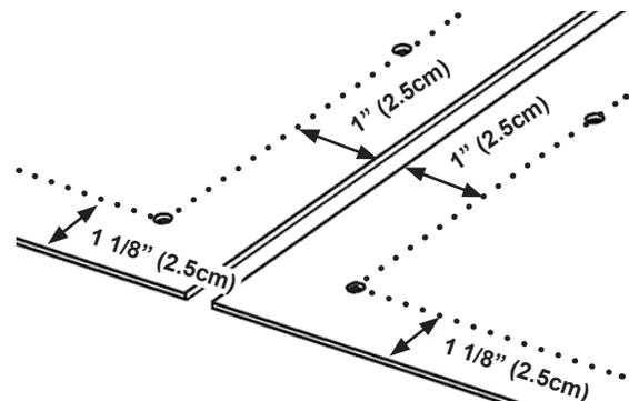
Рис. 171 - Положение отверстий для сращивания полотенного транспортера
