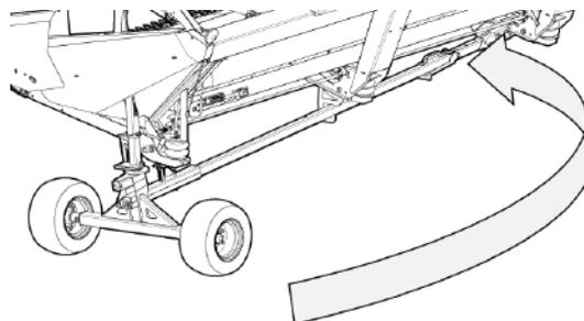
Рис. 262 - Поворот сцепного стержня в положение для хранения.
