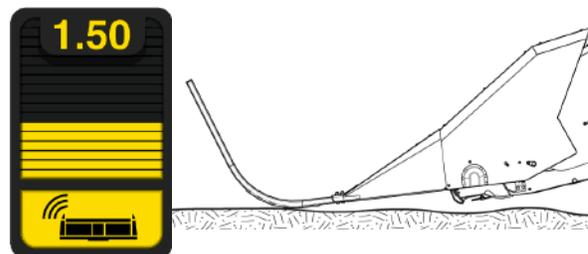
Рис. 121 - Панель оперативных данных – делитель поднят
