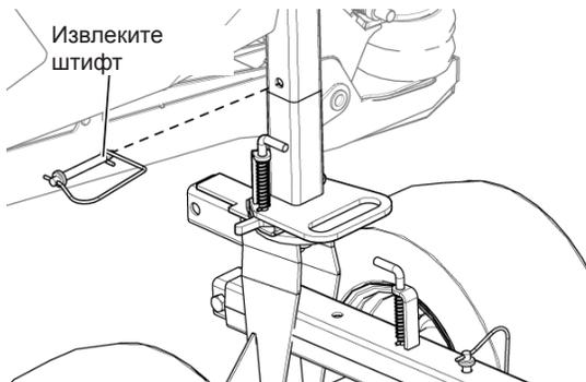
Рис. 48 - Извлечение штифта оси сцепного стержня
