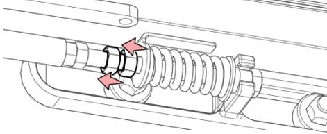
Рис. 164 - Ослабьте стопорные гайки
