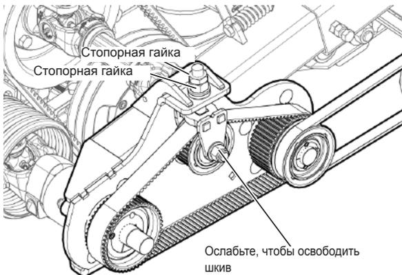
Рис. 152 - Регулировка натяжения первого ремня правого полотенного транспортера
