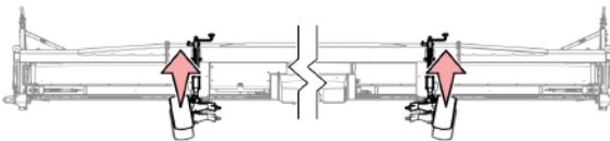
Рис. 98 - Поднятие опорных колес.
