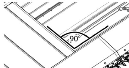
Рис. 160 - Настройка приводного ролика
