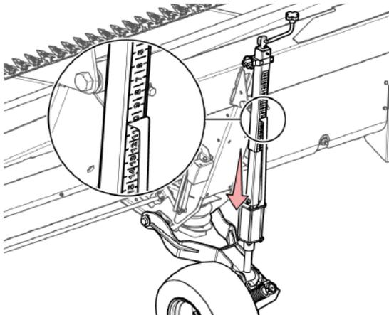
Рис. 64 - Настройте высоту опорного колеса.
