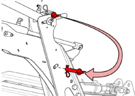
Рис. 174 - Стопорный штифт центрального луча мотовила
