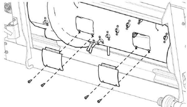
Рис. 230 - Доступ к внутренней части барабана подающего шнека
