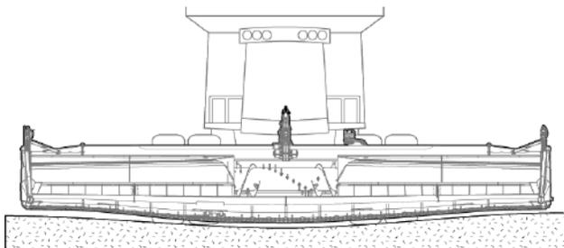
Рис. 36 - Режим гибкой жатки.
