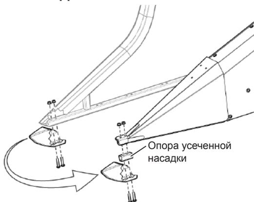
Рис. 226 - Усеченная насадка для бокового делителя.
