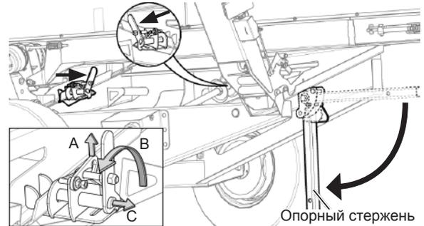
Рис. 49 - Разблокировка транспортного комплекта и опускание опорного стержня.
