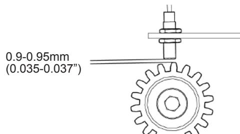
Рис. 127 - Расстояние от сенсора скорости до соответствующей поверхности.
