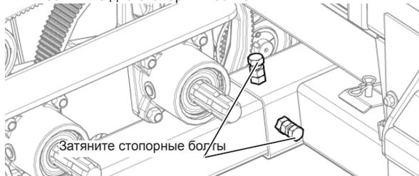
Рис. 149 - Стопорные болты первого приводного ремня левого полотенного транспортера.
