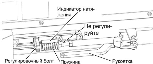
Рис. 157 - Регулировка натяжения полотенного транспортера
