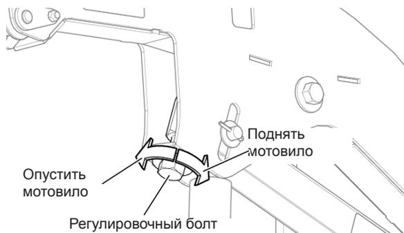
Рис. 66 - Болт для регулировки высоты мотовила.
