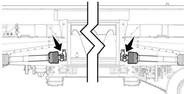
Рис. 259 - Положение приводных валов для хранения.
