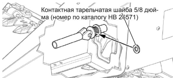
Рис. 223 - Установка дополнительной шайбы для закрепления расшатанной рукоятки.
