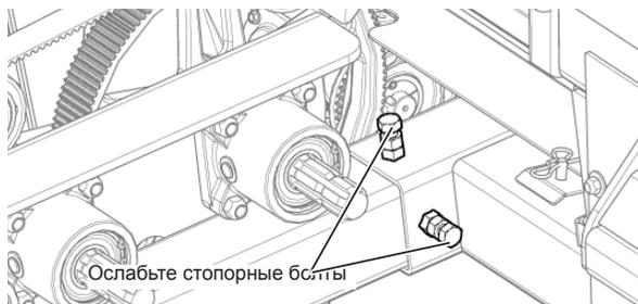
Рис. 147 - Стопорные болты первого приводного ремня левого полотенного транспортера.
