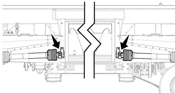
Рис. 267 - Положение приводных валов для хранения.
