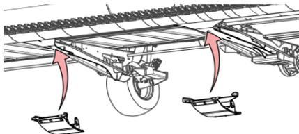
Рис. 74 - Опорные лапы – установленные в месте транспортной тележки
