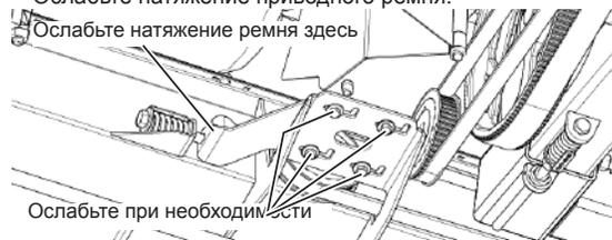
Рис. 150 - Ослабление натяжения приводного ремня левого полотенного транспортера.
