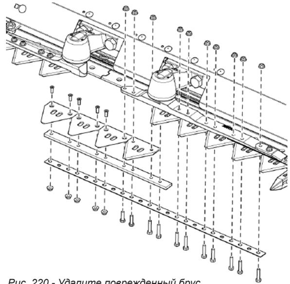
Рис. 220 - Удалите поврежденный брус перекрытия
