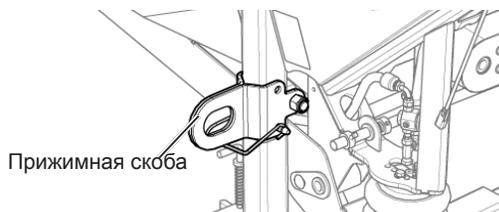
Рис. 47 - Снятие крепежной скобы
