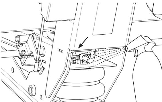
Рис. 249 - Проверка фитингов пневматических подушек на предмет утечек.
