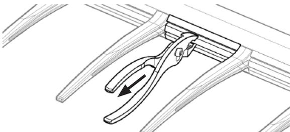
Рис. 179 - Извлечение распорной детали между пальцами мотовила.
