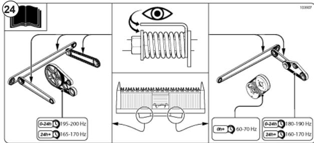
Рис. 27 - инструкции по натяжению конвейера
