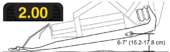
Рис. 60 - Оптимальный угол наклонной камеры.
