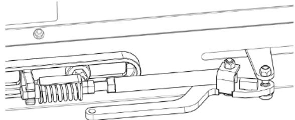
Рис. 85 - Правильное положение рукоятки натяжения полотенного транспортера.
