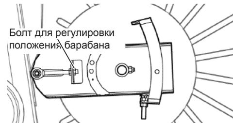
Рис. 229 - Положение барабана подающего шнека.
