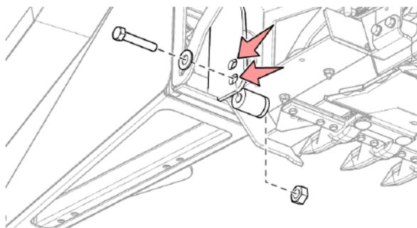
Рис. 93 - Положения блокировки делителей
