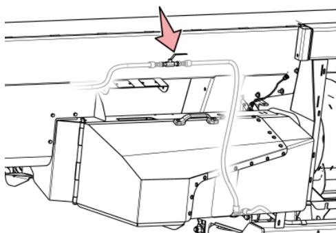
Рис. 108 - Клапан воздушного амортизатора подрамника
