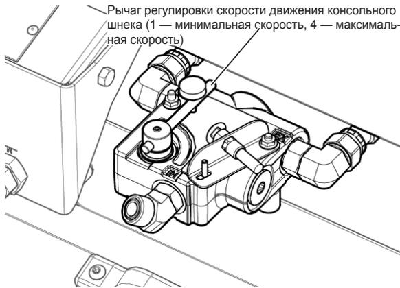
Рис. 80 - Устройство контроля потока урожая (регулятор скорости движения консольного шнека).
