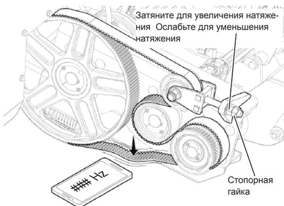
Рис. 133 - Натяжение приводного ремня подающего шнека.
