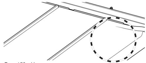
Рис. 159 - Неправильное натяжение полотенного транспортера.
