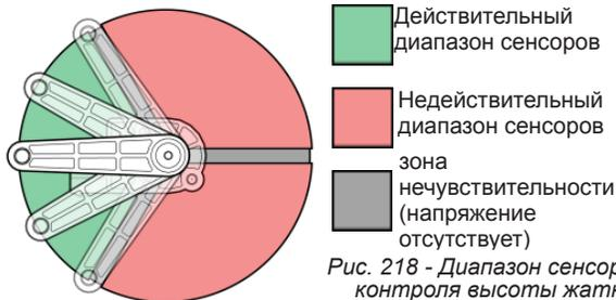
Рис. 218 - Диапазон сенсора контроля высоты жатки
