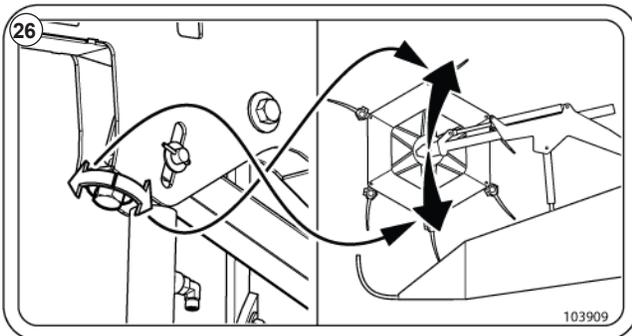
Рис. 29 - Инструкции по использованию луча мотовила.
