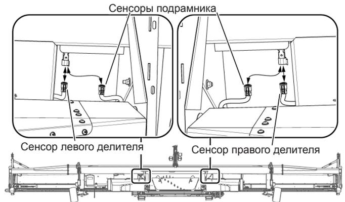
Рис. 103 - Выбор сенсоров при работе в режиме жесткой жатки
