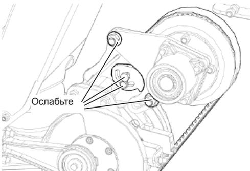
Рис. 145 - Ослабление стопорных механизмов.
