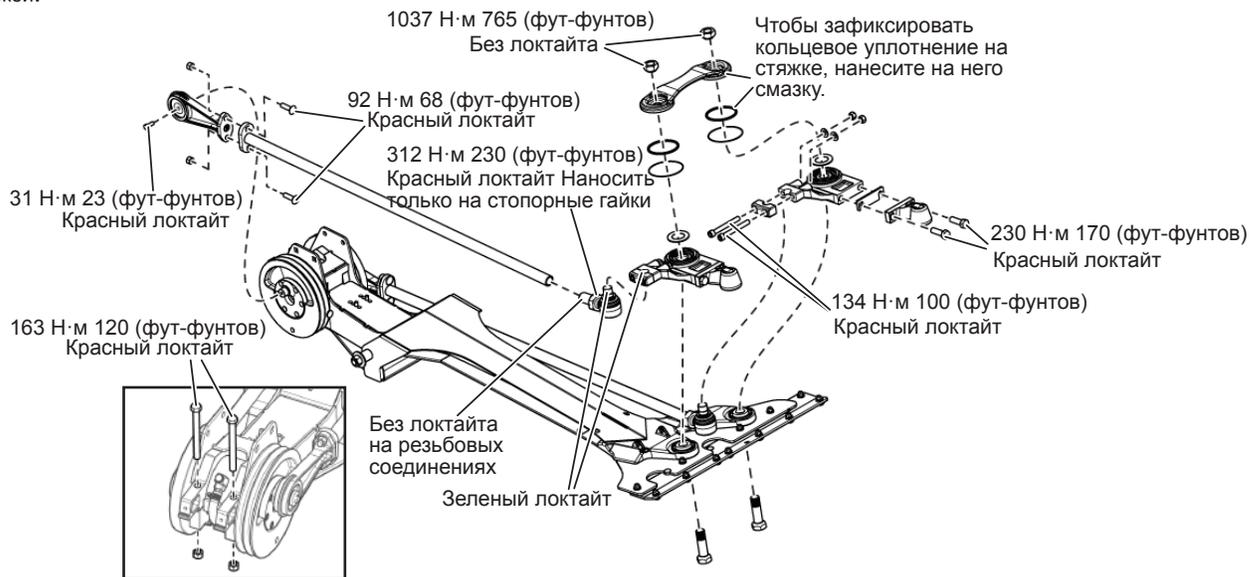
Рис. 195 - Рекомендуемые значения моментов затяжки компонентов привода ножей (подробные сведения см. в разделе разделе 22.8 на стр. 156)
