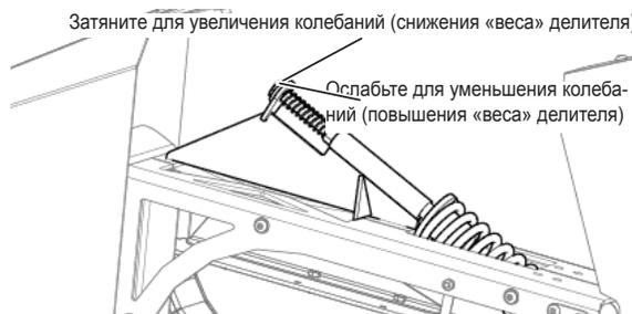
Рис. 227 - Регулировка параметров колебаний пружин боковых делителей.
