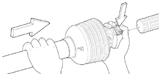
Рис. 57 - Подсоединение механизма отбора мощности.
