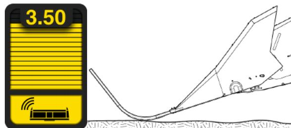
Рис. 120 - Панель оперативных данных – полный диапазон движения делителя доступен
