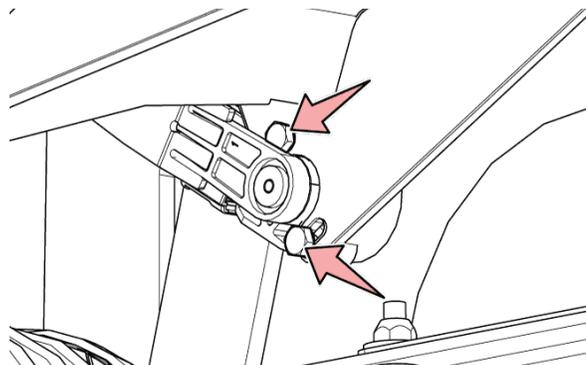
Рис. 246 - Регулировка сенсора подрамника
