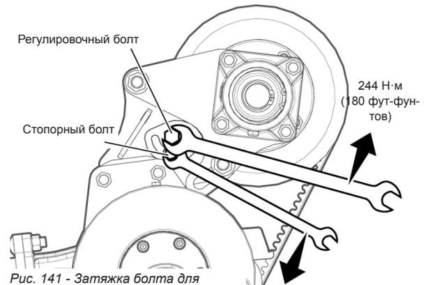
Рис. 141 - Затяжка болта для натяжения ремня.
