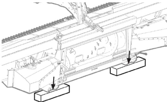
Рис. 266 - Установка жатки на блоки.
