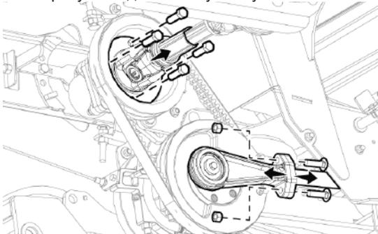
Рис. 144 - Отсоединение соединительной тяги и механизма отбора мощности.
