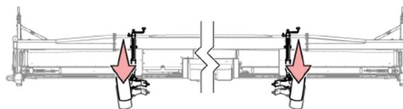
Рис. 110 - Опускайте опорные колеса до тех пор, пока они не коснутся почвы
