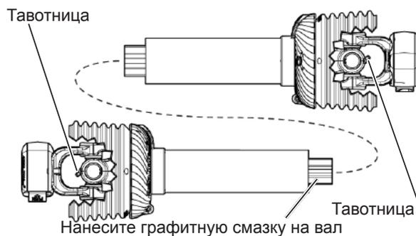
Рис. 238 - Точки нанесения смазки на приводной вал.
