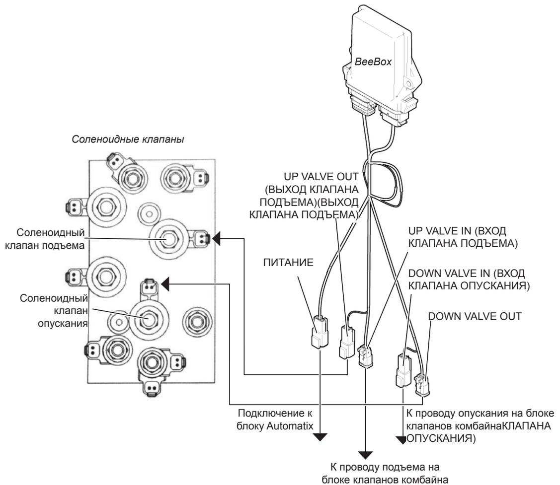
Рис. 281 - Устройство ВееВох, предназначенное для использования на комбайнах с двухпозиционными распределительными клапанами.
