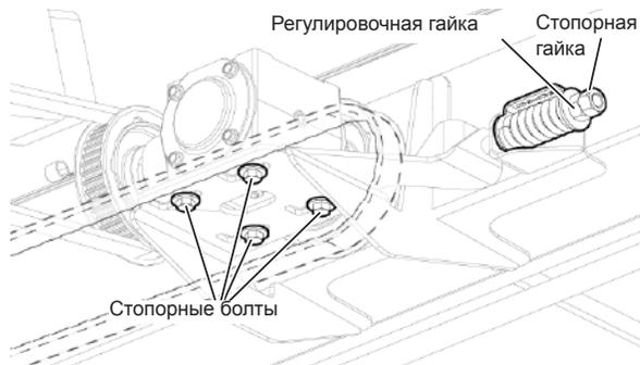
Рис. 156 - Регулировка натяжения второго ремня правого полотенного транспортера.
