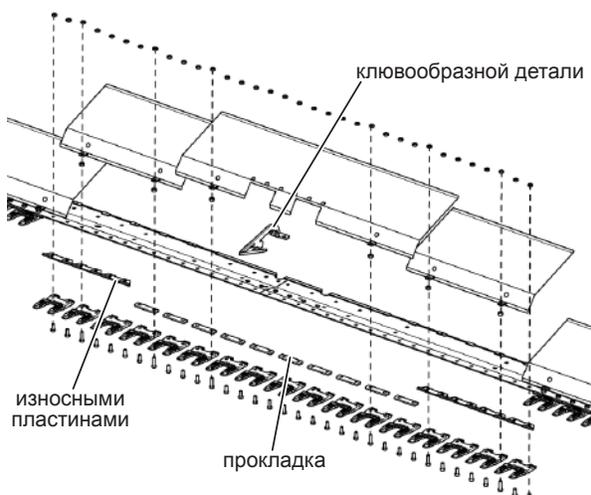
Рис. 200 - Компоновка низкопрофильной режущей системы
