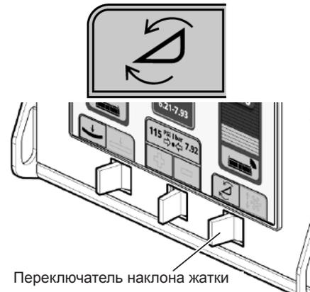
Рис. 86 - Активация режима наклона жатки
