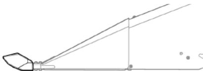
Рис. 95 - Усеченная насадка для бокового делителя
