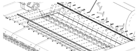
Рис. 170 - Закрепление полотненного транспортера с помощью соединительных стержней.
