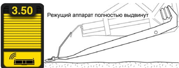
Рис. 103 - Панель оперативных данных - Доступен полный диапазон движения режущего аппарата
