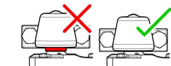
Рис. 188 - Проверка правильности установки корпуса подшипников
