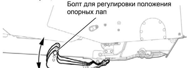
На новых заводских жатках с установленной дополнительной транспортной тележкой необходимо установить две опорные лапы на ближайшие к транспортной тележке лопатки после ее снятия.
