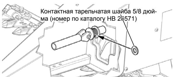
Рис. 197 - Установка дополнительной шайбы для закрепления расшатанной рукоятки.
