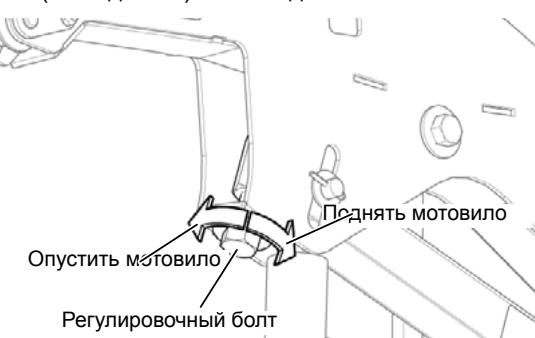
Рис. 160 - Болт для регулировки высоты мотовила.
