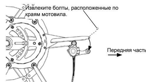
Рис. 231 - Опускание пальцев мотовила для транспортировки
