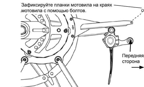
Рис. 35 - Поднятие пальцев мотовила в рабочее положение.
