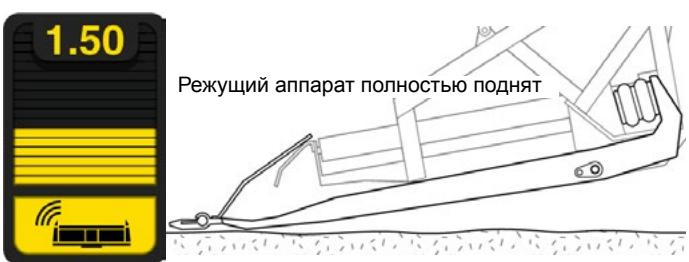
Рис. 104 - Панель оперативных данных - Режущий аппарат поднят
