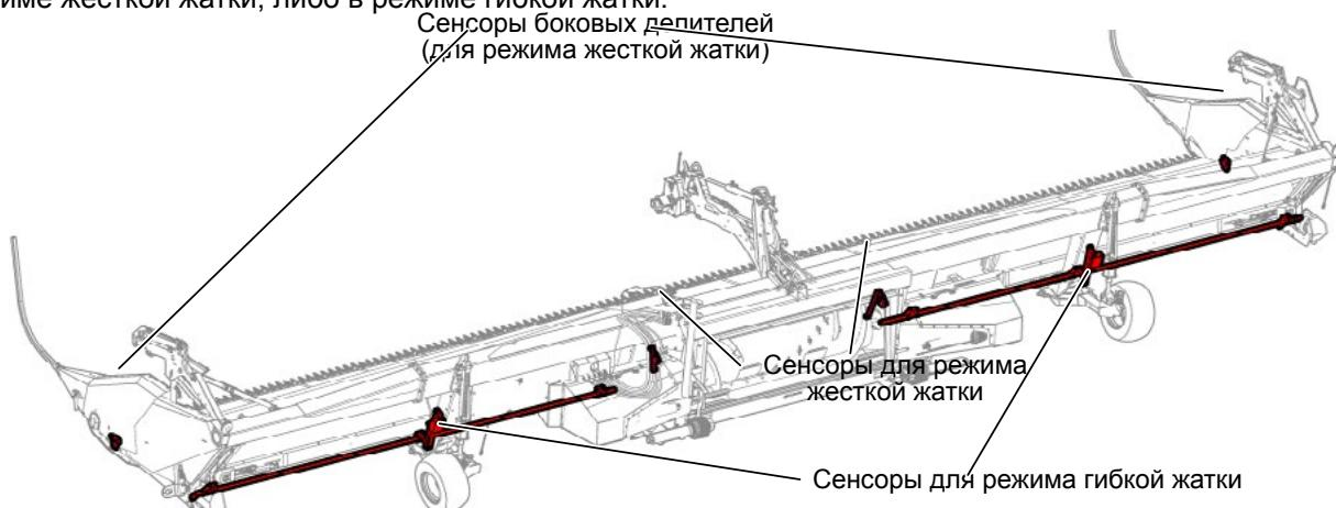
Рис. 243 - Места расположения сенсоров системы контроля высоты жатки.
