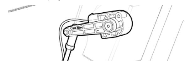
Рис. 217 - Выравнивание сенсоров высоты жатки в режиме гибкой жатки
