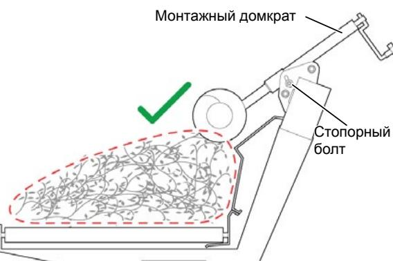
При движении на небольшом расстоянии от задней панели консольный шнек может входить в соприкосновение с этой панелью. Расстояние между консольным шнеком и задней панелью должно составлять не менее (3/4 дюйма).
