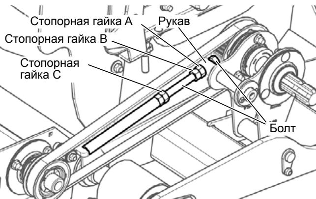
Рис. 121 - Регулировка натяжения приводного ремня центрального полотенного транспортера
