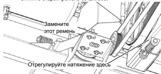
Рис. 133 - Снятие первого ремня левого полотенного транспортера.
