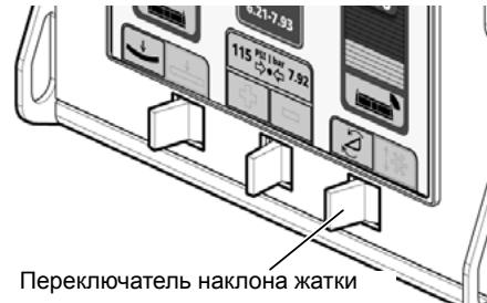
Переключатель наклона жатки
