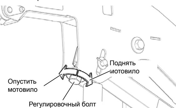
Рис. 56 - Болт для регулировки высоты мотовила.
