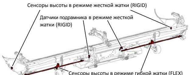
Рис. 32- Места расположения сенсоров системы контроля высоты жатки AirFLEX
