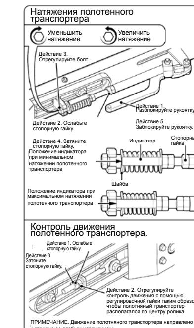
Рис. 19 - Натяжение и контроль движения полотенного транспортера.
