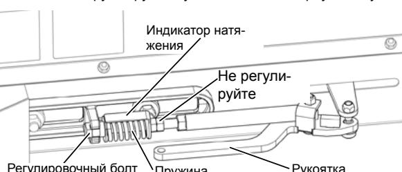
Рис. 142 - Регулировка натяжения полотенного транспортера
