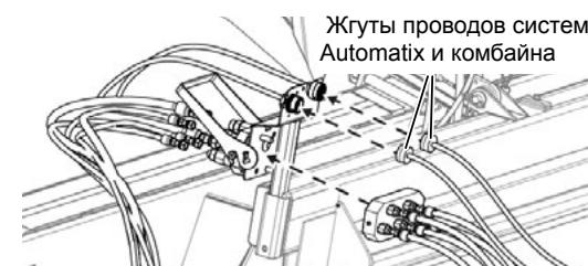
Рис. 44 - Подсоединение многоцелевого разъема и жгутов проводов.
