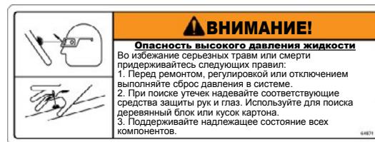
Рис. 4 - Опасность в связи с жидкостями высокого давления.
