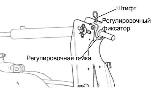
Рис. 161 - Регулировка высоты центрального луча мотовила.
