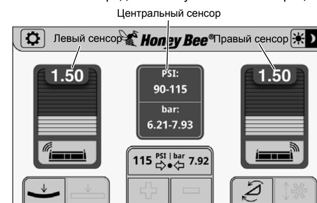
Рис. 244 - Идентификация сенсоров системы контроля высоты жатки на дисплее Automatix.
