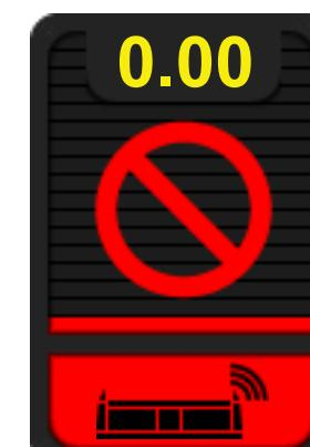
Рис. 111 - Предупреждение! Датчик высоты жатки не обнаружен!
