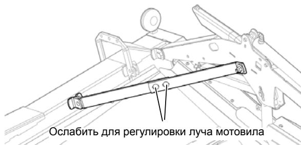
Рис. 59 - Выравнивание мотовила по центру
