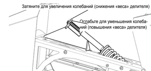
Рис. 201 - Регулировка параметров колебаний пружин боковых делителей.
