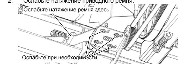
Рис. 135 - Ослабление натяжения приводного ремня левого полотенного транспортера.
