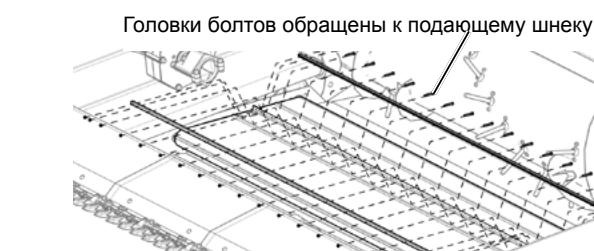
Рис. 155 - Закрепление полотенного транспортера с помощью соединительных стержней.
