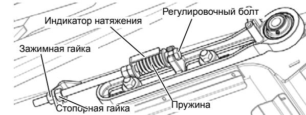
Рис. 147 - Настройка натяжения центрального полотенного транспортера
