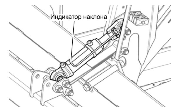
Рис. 74 - Гидравлический цилиндр и индикатор наклона
