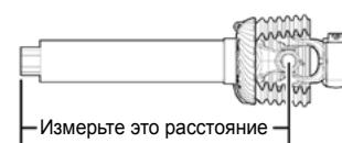
Рис. 248 - Измерение вала
