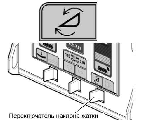
Рис. 73 - Активация режима наклона жатки
