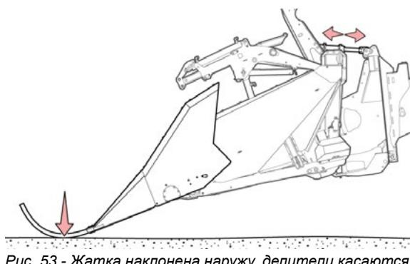
Рис. 53 - Жатка наклонена наружу, делители касаются земли
