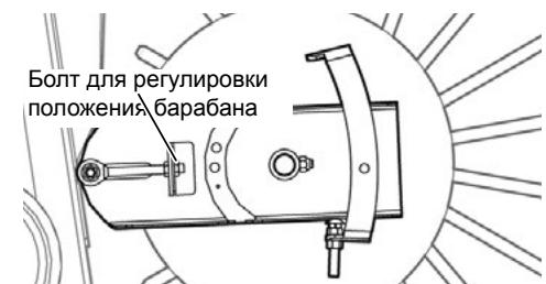
Рис. 203 - Положение барабана подающего шнека.
