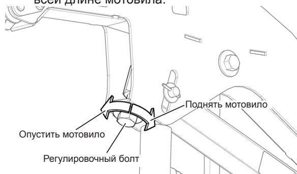
Рис. 181. Болт для регулировки высоты мотовила.
