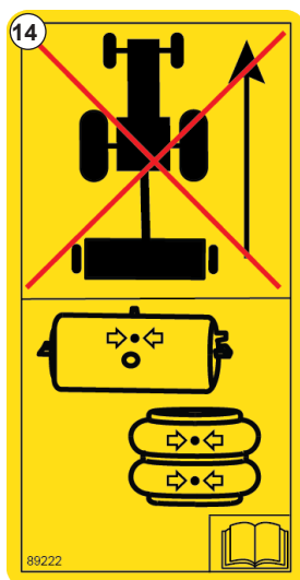
Рис. 17. Не осуществляйте транспортировку, если из пневматических подушек выпущен воздух.
