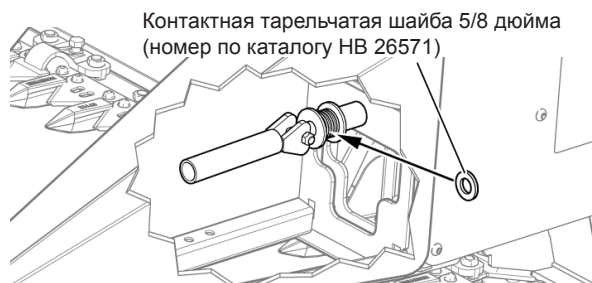
Рис. 201. Установка дополнительной шайбы для закрепления расшатанной рукоятки.
