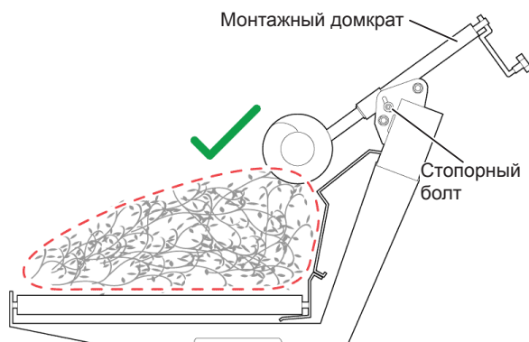
Рис. 60. Регулировка расстояния между прижимным устройством и режущей секцией.
