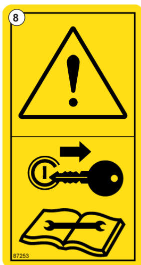
Рис. 11. Для технического обслуживания выключите двигатель.
