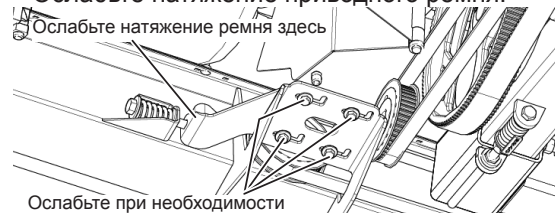
Рис. 163. Ослабление натяжения приводного ремня левого полотенного транспортера.
