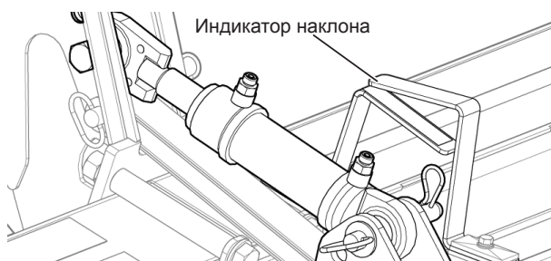
Рис. 69. Гидравлический цилиндр и индикатор наклона.
