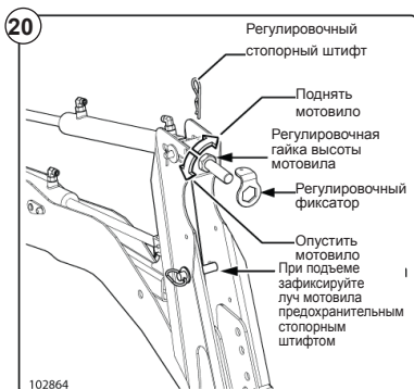
Рис. 23. Инструкции по использованию центрального луча мотвила.
