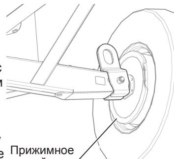
Рис. 139. Прижимное устройство оси.
