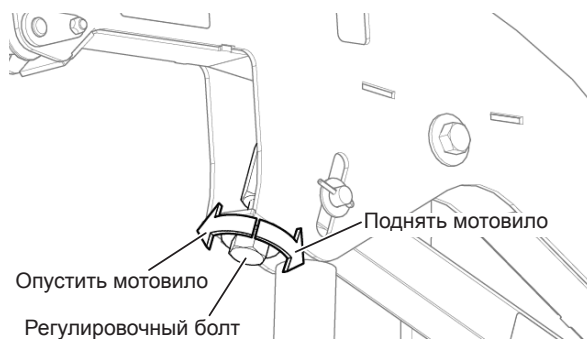
Рис. 50. Болт для регулировки высоты мотовила.
