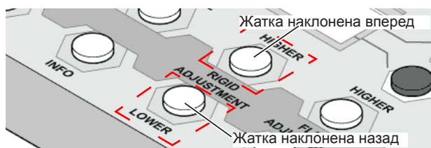
Рис. 68. Выбор режима наклона с помощью кнопок RIGID ADJUSTMENT (РЕГУЛИРОВКА РЕЖИМА ЖЕСТКОЙ ЖАТКИ).
