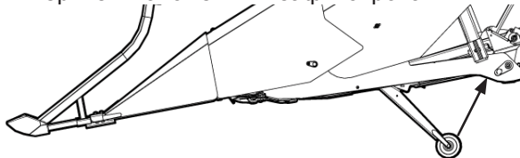
Рис. 79. Подъем и закрепление центрального датчика (датчиков).
