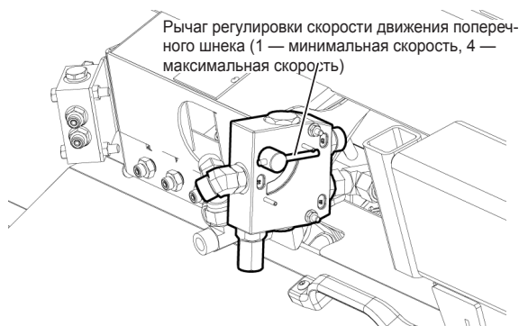
Рис. 63. Устройство контроля потока урожая (регулятор скорости движения поперечного шнека).
