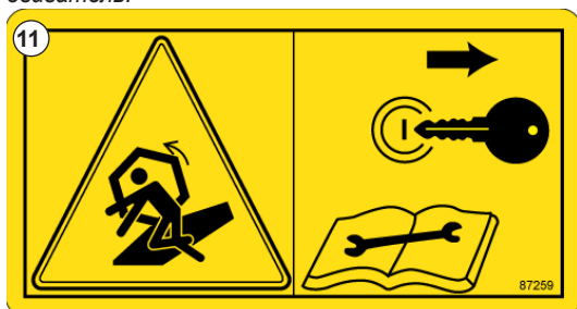
Рис. 14. Для технического обслуживания мотовила выключите двигатель.
