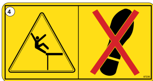
Рис. 7. Ступенька отсутствует: опасность падения.
