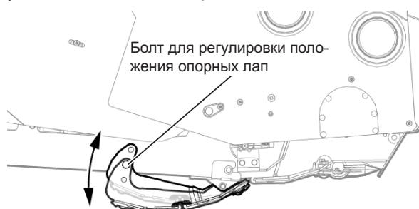
Рис. 59. Два положения опорных лап.
