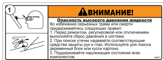
Рис. 4. Опасность в связи с жидкостями высокого давления.
