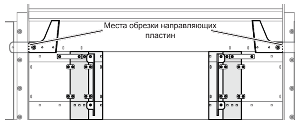
Рис. 231. Гнезда AGCO: схема 6.
