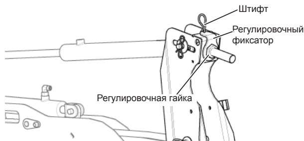
Рис. 182. Регулировка высоты центрального луча мотовила.
