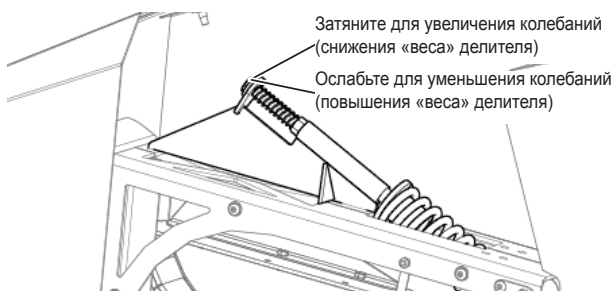
Рис. 206. Регулировка параметров колебаний пружин боковых делителей.
