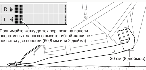
Рис. 48. Оптимальный угол наклонной камеры при использовании низкопрофильных лопаток.
