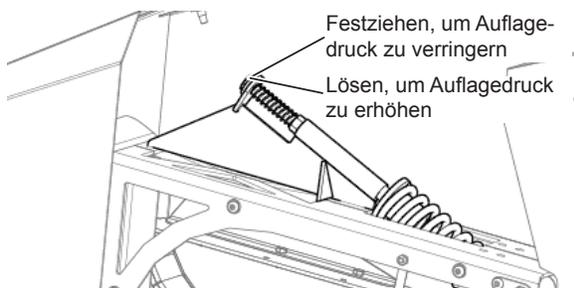
Abb. 207: Auflagedruckfeder des Halmteilers
