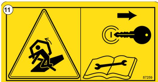
Abb. 14: Bei Arbeiten an der Haspel Motor ausschalten
