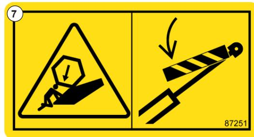
Abb. 10: Vor Arbeitsbeginn Haspelabsenksicherung aktivieren
