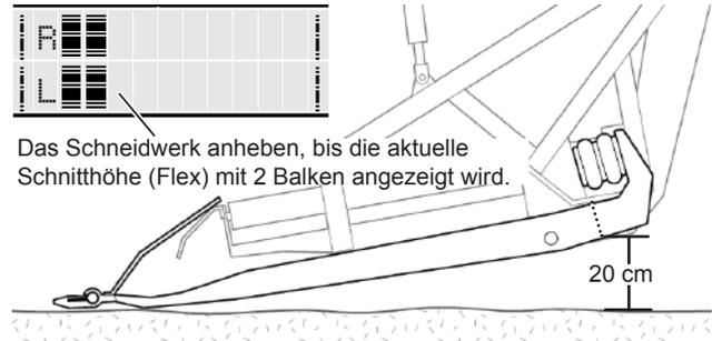
Abb. 50: Optimaler Schrägfördererwinkel
