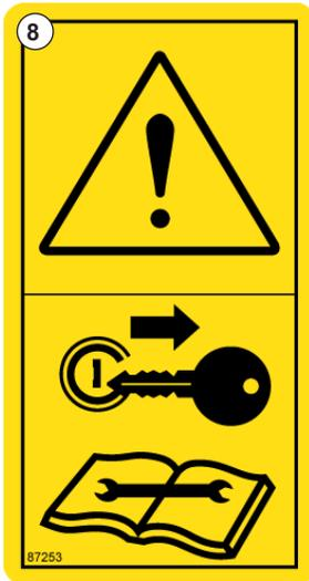
Abb. 11: Bei Arbeiten Motor ausschalten
