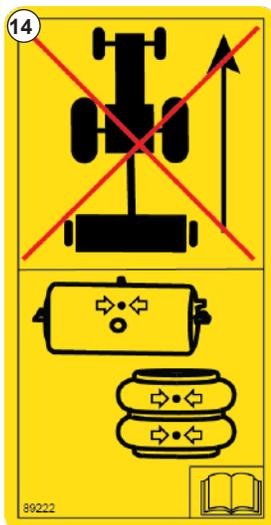
Abb. 17: Nicht mit leeren Luftkissen transportieren
