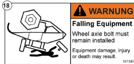
Abb. 21: Achsschraube nicht entfernen
