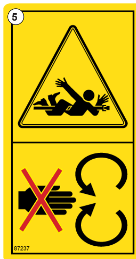
Abb. 9: Abstand zu umlaufender Antriebswelle halten
