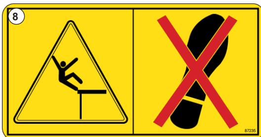
Abb. 11: Nicht betreten! Sturzgefahr
