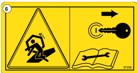
Abb. 8: Bei Arbeiten an der Haspel Motor ausschalten
